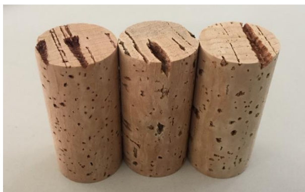
Figura 8 - Rolhas com defeitos nos topos
