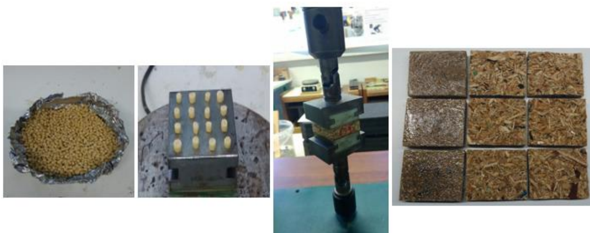
Figura 17- Hot-melt, disposição da cola na superfície do suporte de ensaio, amostra na máquina de ensaios e conjunto de amostras após ensaio de resistência interna
