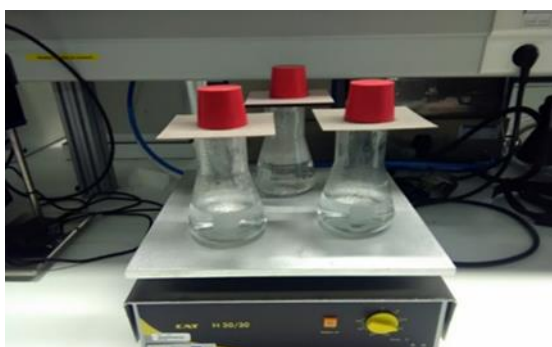
Figura 15- Equipamento utilizado no ensaio da resistência ao vapor de água
