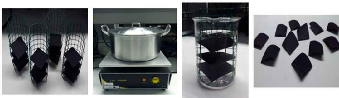
Figura 16- Etapas do ensaio de água em ebulição: preparação, fervura, arrefecimento e análise
