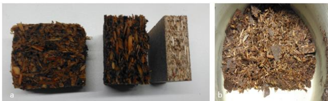
Figura 30- Amostras de PB após 10 min (a) e 25 min (b) de ensaio em água em ebulição
