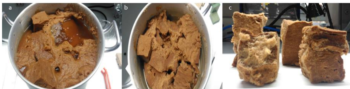
Figura 35- Amostras de MDF ao longo do ensaio de água em ebulição e no final
