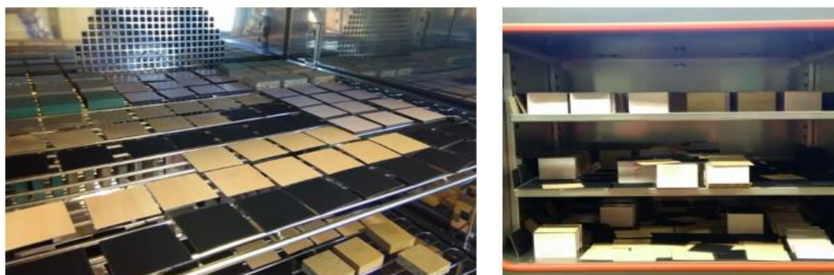
Figura 13- Acondicionamento das amostras de HPL na câmara e na estufa respetivamente
