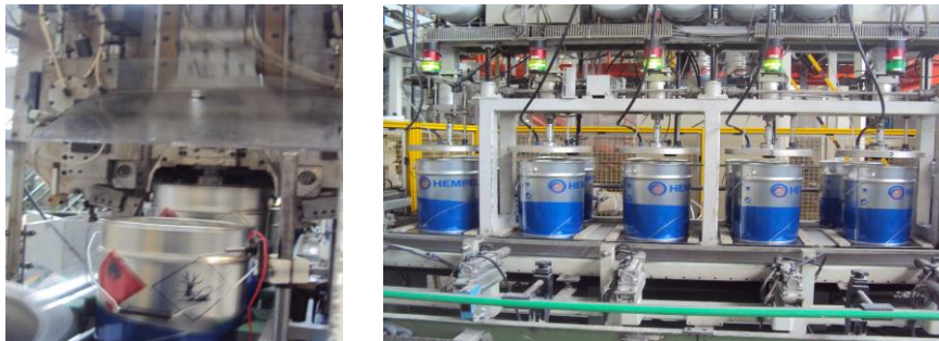
Figura 16 - Colocação do arco(esq.) e teste de estanquicidade(dir.)
