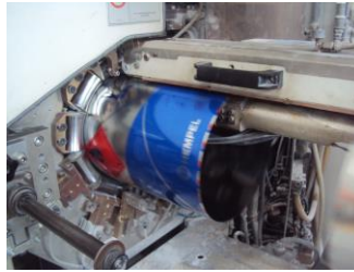
Figura 11 - Saída da máquina de soldar e aplicação de verniz pó
