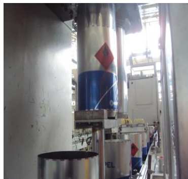
Figura 13 - Expansora (esq.), Máquina de rebordo e canal (meio), Baldes à saída da máquina do rebordo e canal (dir.)
