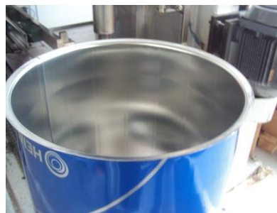
Figura 14 - Balde à saída da máquina da beira
