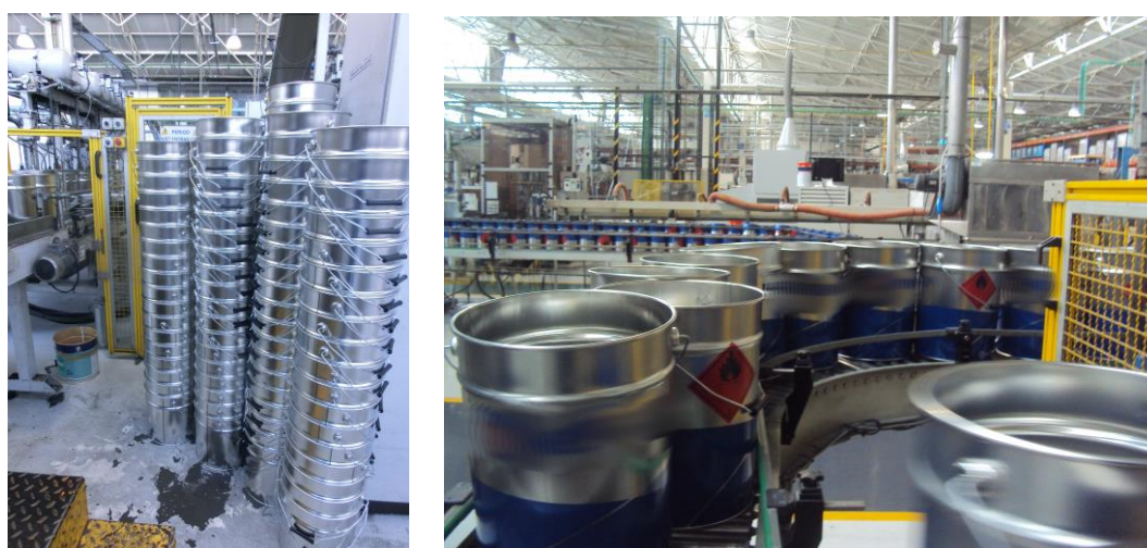
Figura 23 - Baldes rejeitados à espera de reavaliação e no tapete de rejeitados
