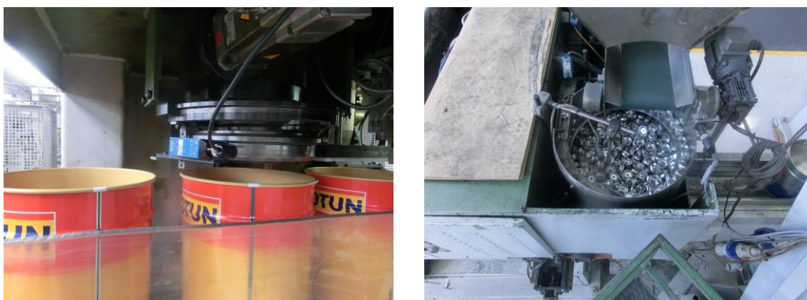
Figura 21 - Posicionador dos Olhais (esq.) e Vibrador dos olhais (dir.)
