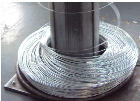
Figura 29 - Bobine sem ponta inferior visível
