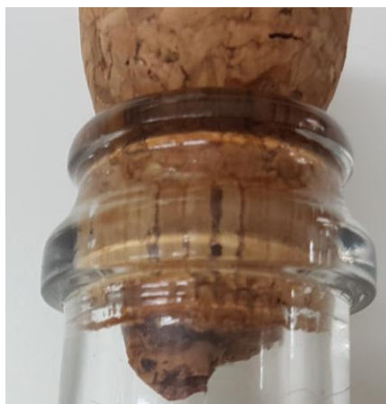
Figura 24 - Rolha quebrada no rolhamento
