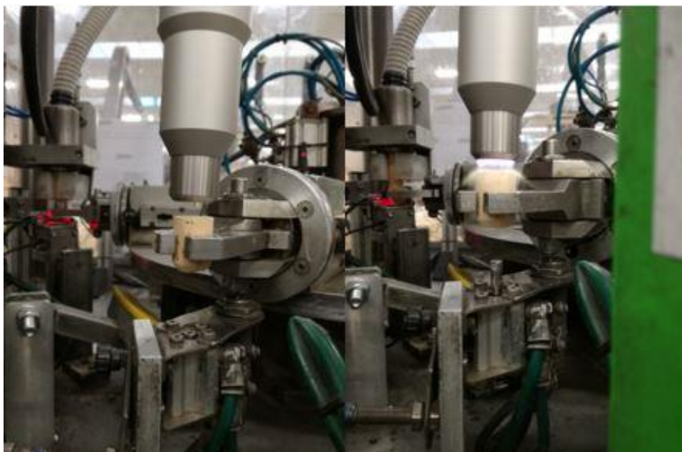
Figura 4.20-Equipamento de plasma em funcionamento.
