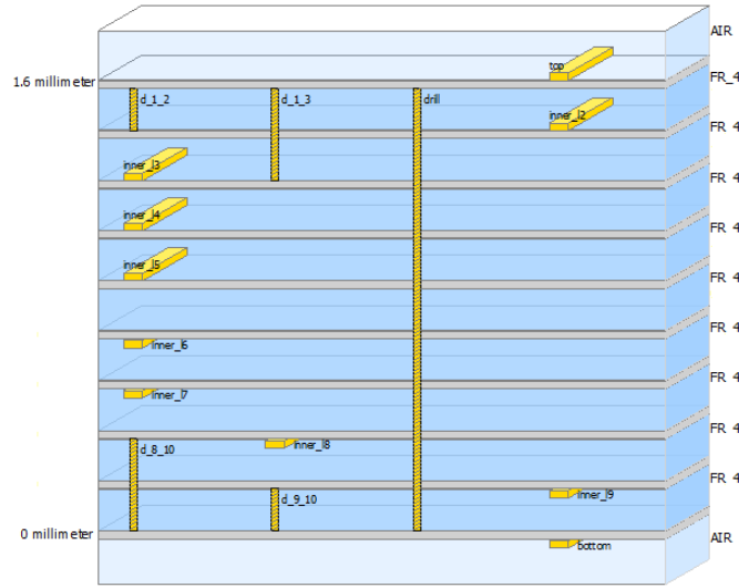
Figura 3.4: Organização estrutural da PCB.
