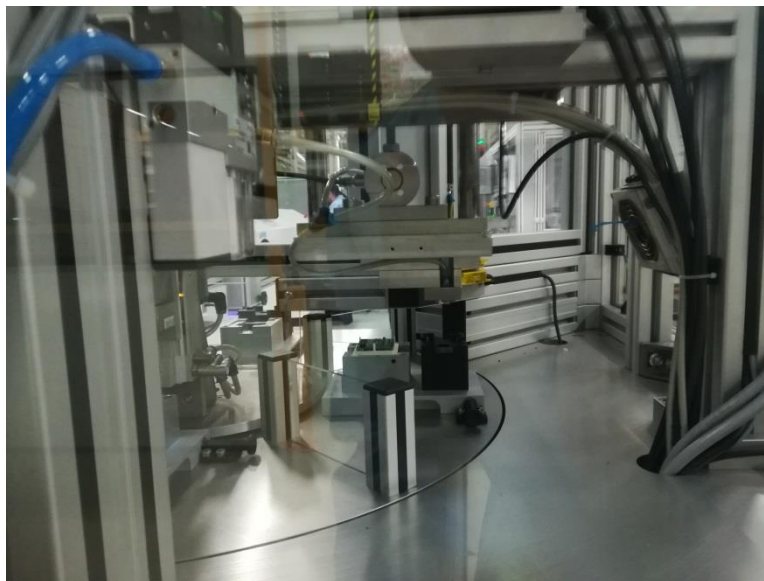
Figura 36 - Processo de cravação do PCBA no conector ( press fit )
