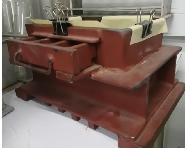
Figura 16 - Molde utilizado para a produção de poliuretanos moldados
