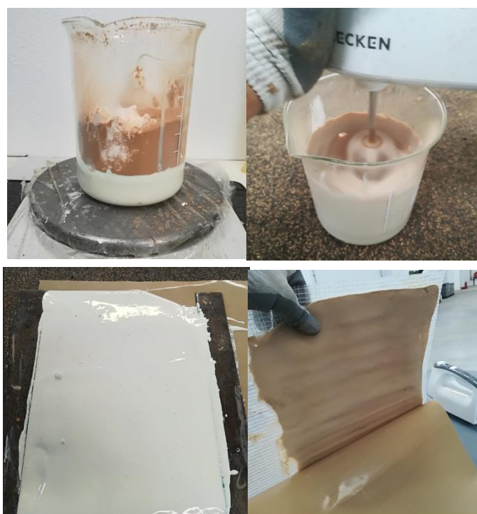
Figura 15 - Processo de esponjamento de resinas acrílicas
