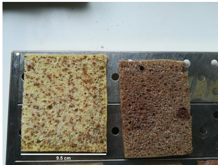
Figura 36 - Amostras sujeitas a ensaio de envelhecimento, espuma com cortiça 1 (esquerda) e cortiça 5 (direita)
