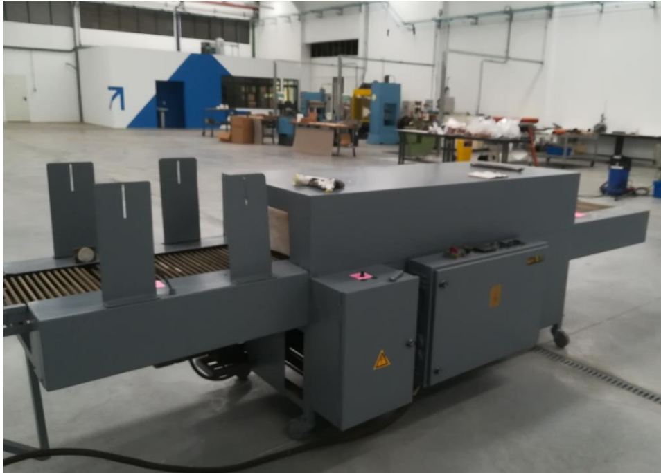
Figura 27 - Equipamento piloto (Estufa com correia transportadora)
