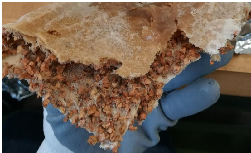
Figura 17 - Espuma de resina acrílica esponjada com cortiça de maior diâmetro de grão
