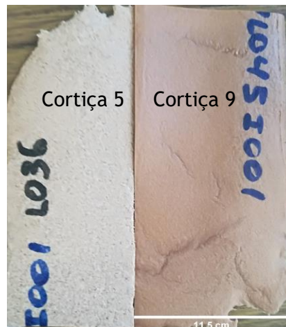
Figura 22- Fenômeno de fissurização presente para espumas com cortiça 9
