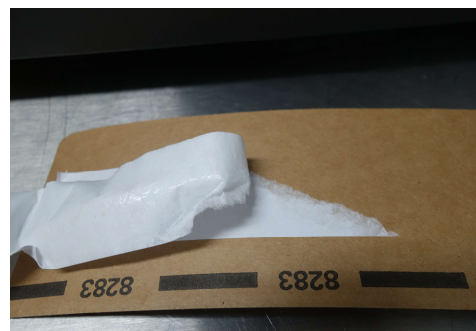
Figura 30. Fotografia representativa da ocorrência de paper tear em cartão.
