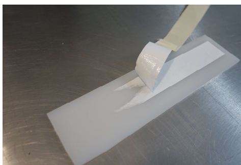
Figura 31. Fotografia representativa da ocorrência de paper tear em HDPE.
