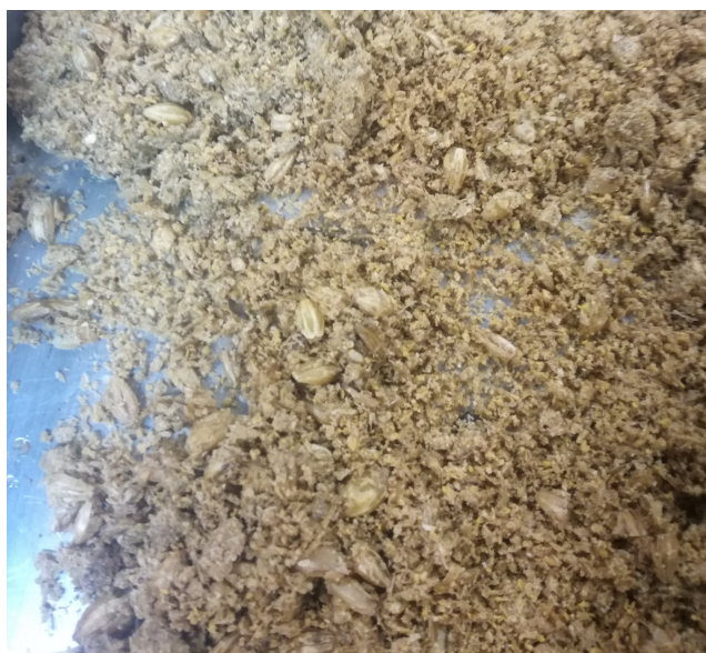
Figura 28 - Exemplo de má moagem do malte
