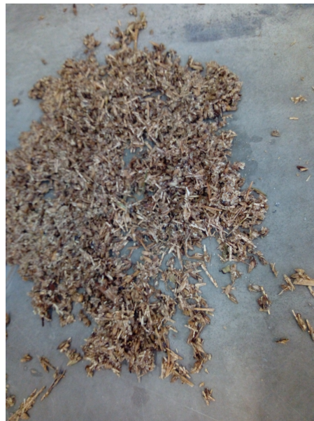
Figura 23 - Palhas após colmatação do filtro
