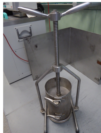
Figura 8 - Prensa utilizada na obtenção de extrato solúvel
