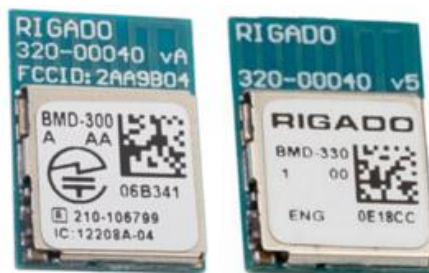
Figura 23: Módulos Rigado: BMD-300 [36] e BMD-330 [38]
