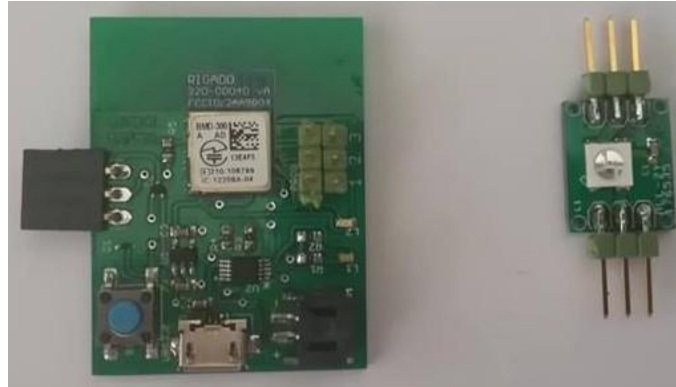
Figura 65: Fotografia dos circuitos implementados, estando representado, à esquerda o circuito principal e à direita o circuito do LED endereçável
