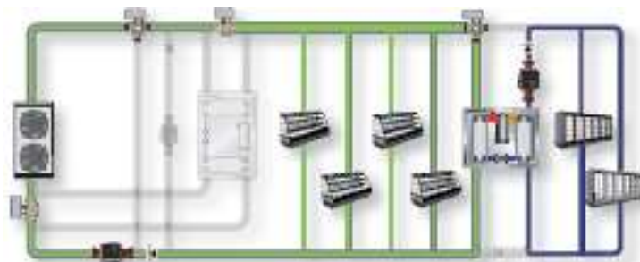
Figura 14 - Esquema representativo do modo de ativação do chiller água-água. [33]
