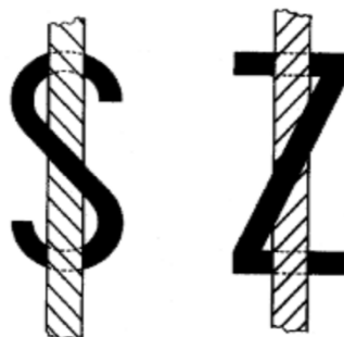
Figura 8. Representação das direções de torção S e Z adaptado de (Khurana e Sethi, 2007).
