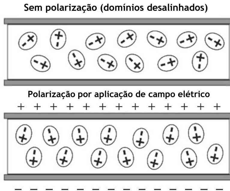
Figura 2.4: Polarização por aplicação de campo elétrico (orientação dos dipolos elétricos) (adaptado) [21].
