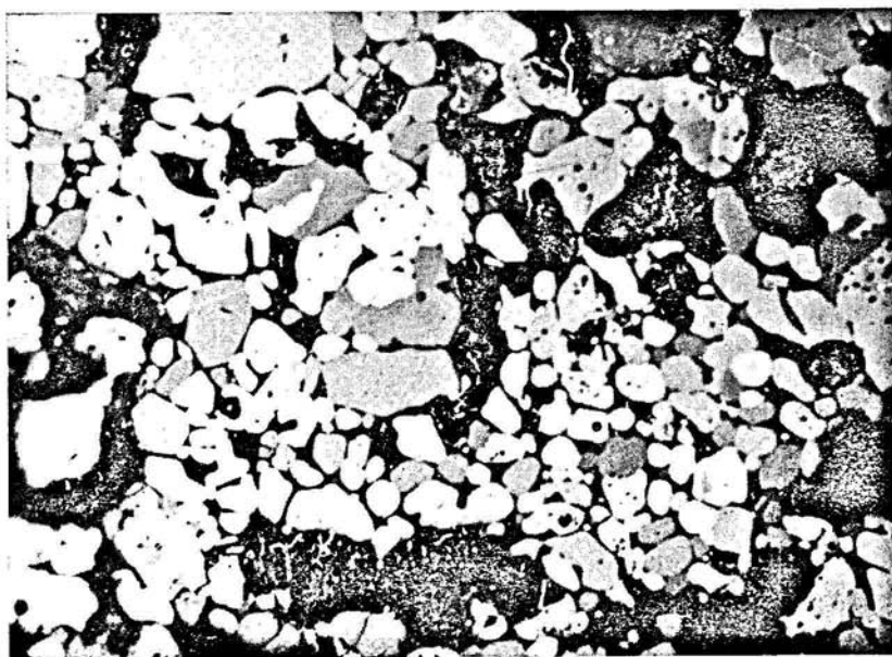
Fig. 111 — Microfotografia da zona periférica de uma «pellet» fabricada com minério de hematite cozida num aparelho Gate-Kiln a 1350° C. Os cristais de hematite recrystalizaram e uma parte foi dissolvida na ganga para formar um vidro cimentando os óxidos. Os cristais de hematite tem uma forma arredondada. Amostra M-1. Luz reflectida polarizada (nicois descruzados de 6°). Ampl. 400 ×.
