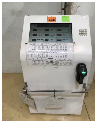
Figura 10 - Quiosque de registo dos dados no chão de fábrica.
