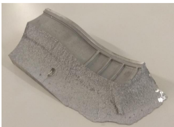
Figura 29 – Parte fraturada que se separou do molde META 35,5 após aplicação de força na zona da fenda
