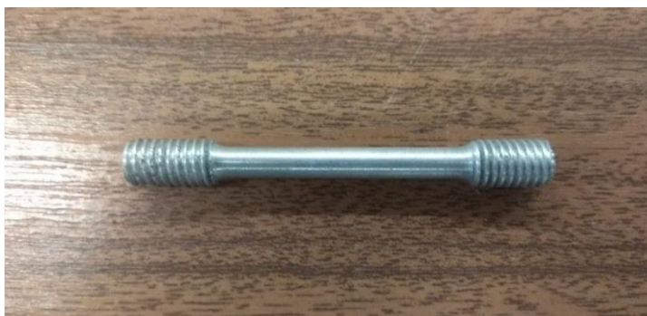
Figura 37 – Provetes utilizados nos ensaios de tração, que seguem a norma ISO 6892-1 2012
