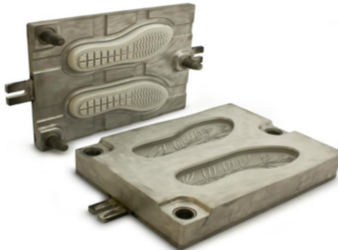
Figura 18 – Base e tampa de molde para fabrico de solas para calçado através do processo de moldação por compressão [33]
