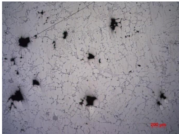
Figura 40 – Microestrutura da amostra retirada de uma das partes que se separou do molde META 35, onde se observam defeitos ocupando 1,99 % da área total
