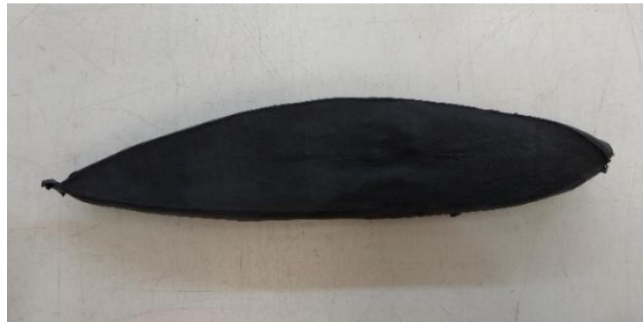
Figura 9 – Pré-formado em borracha para a produção de solas para calçado através do método de moldação por compressão
