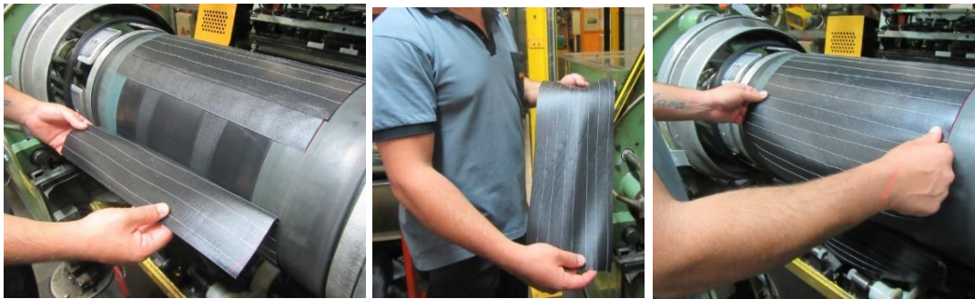
Figura 2.24 - Sequência de ações para a regularização manual da distância entre emendas na carcaça.
