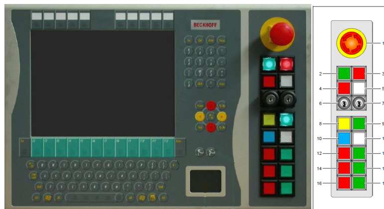
Figura 4.1 - Painel de comandos instalado nas máquinas de construção de pneus da CMIP e numeração dos botões do painel [21].
