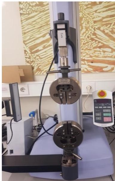
Figura 16 - Equipamento de tração Shimadzu ez test ez-lx
