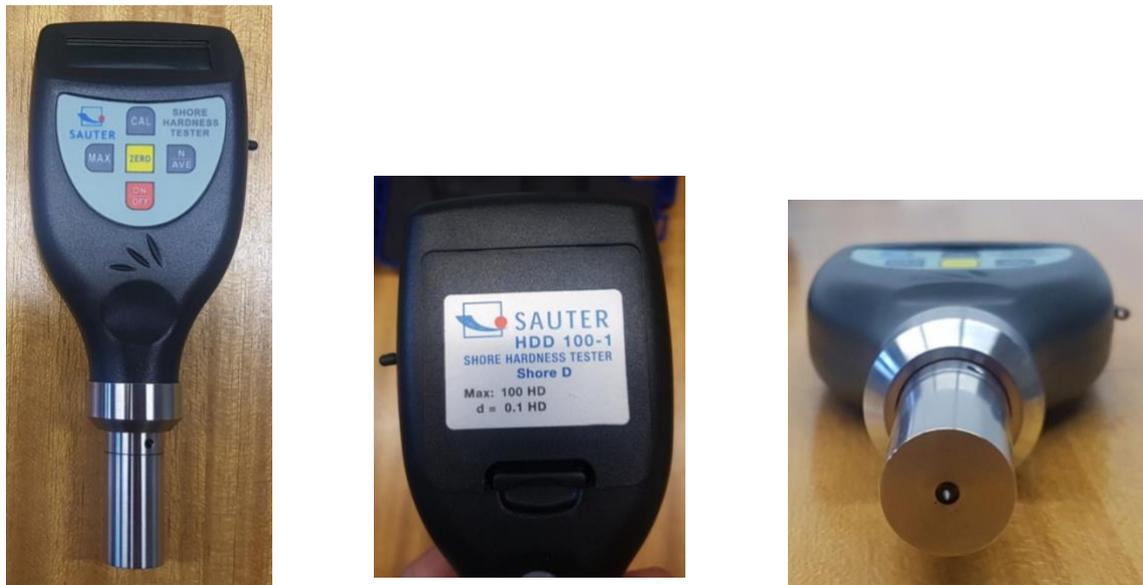
Figura 14 - Durómetro Shore D do DEMM, FEUP
