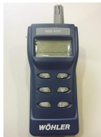
Figura 3.3 Medidor de CO<sub>2</sub> e CO
