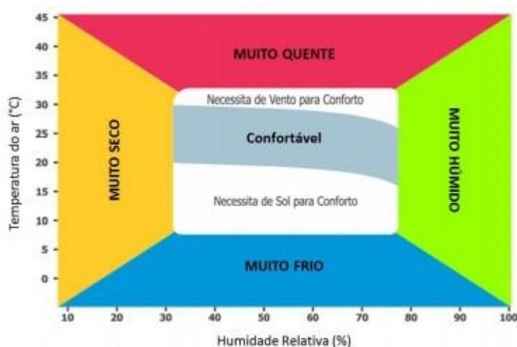
Figura 2.3 Diagrama de conforto térmico em função da temperatura e da humidade (fonte: Abrantes 2012)
