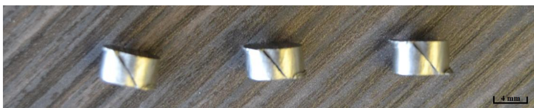
Figura 6.1 – Estado final dos provetes de compressão após os ensaios quase-estáticos.
