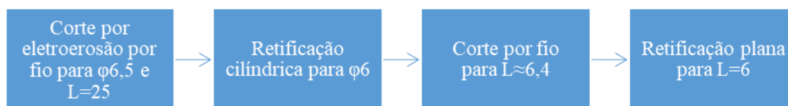
Figura 5.1 – Sequência de processos para a obtenção dos provetes cilíndricos φ6x6.
