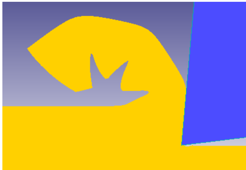
Figura 7.10 – Geometria serrilhada da apara obtida das simulações (ex: \alpha=5^\circ , f=0,15 mm/rot, v=100 m/min).
