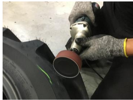
Figura 4.7 - Raspagem e polimento da área retocada [25].
