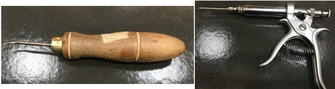
Figura 4.3 - Equipamentos de picagem de bolhas: equipamento de picagem de bolhas exteriores (esquerda); seringa de picagem de bolhas da camada interior (direita) [25].
