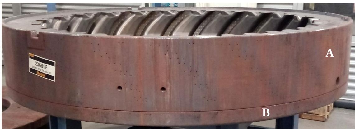
Figura 10.1 – Moldes bipartidos usados na secção dos pneus agrícolas da Continental: A – Contentor; B – Parede lateral.
