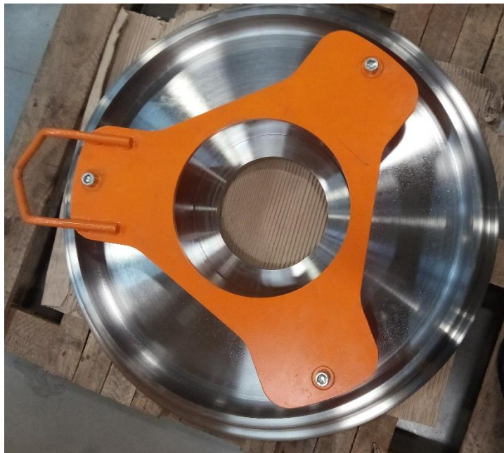
Figura 9.18 - Jante de 32 polegadas produzida para a máquina de RRO.
