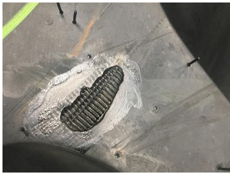
Figura 4.6 - Aplicação do composto de borracha na região a retocar [25].
