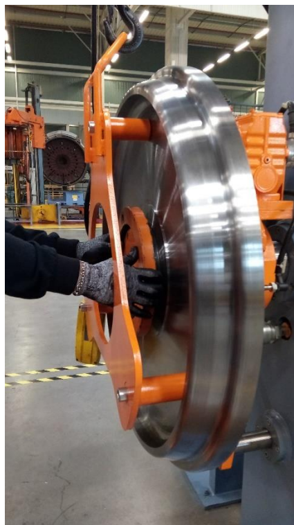
Figura 9.19 - Jante de 32 polegadas a ser montada na máquina de RRO.
