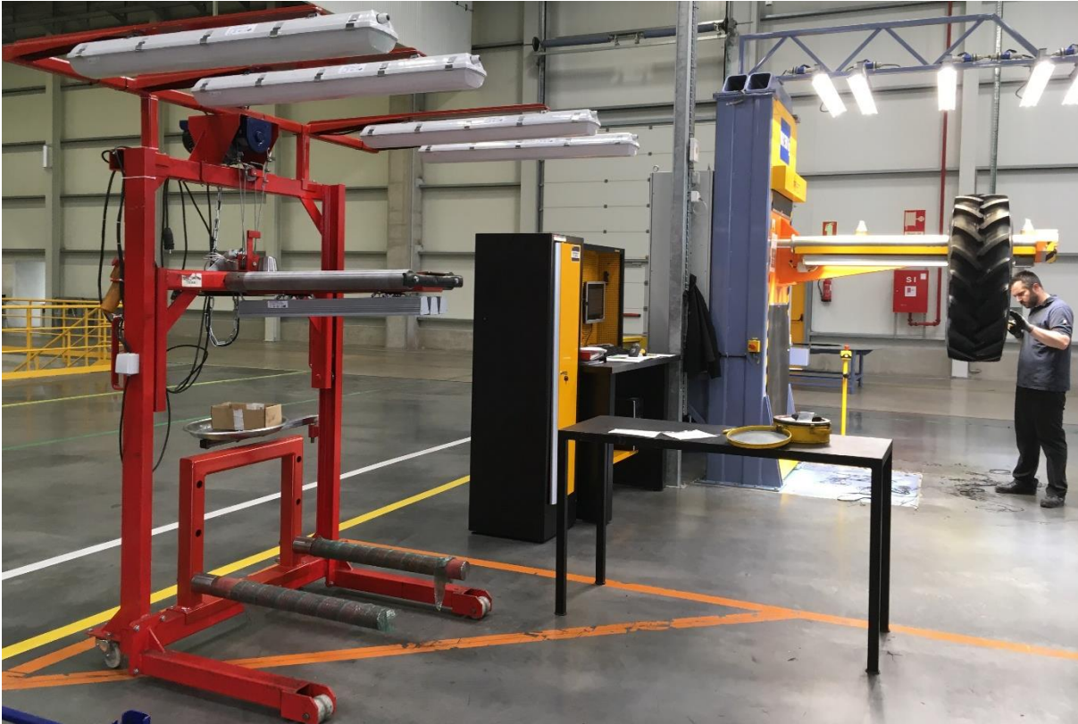
Figura 7.8 – Suporte adaptado para a realização da validação dos pneus agrícolas.
