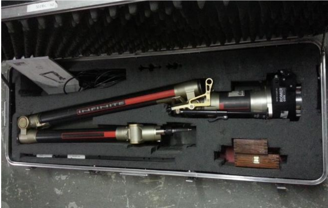
Figura 9.11 - Equipamento de medição tridimensional CIMCORE Modelo 5028 [39].
