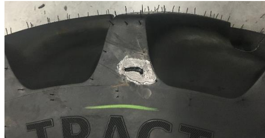
Figura 4.5 - Aplicação do cimento na área a retocar [25].
