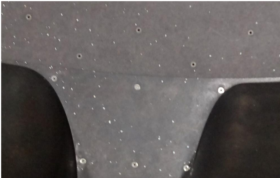
Figura 10.2 – Minivents presentes nos moldes bipartidos usados na produção de pneus agrícolas da Continental.
