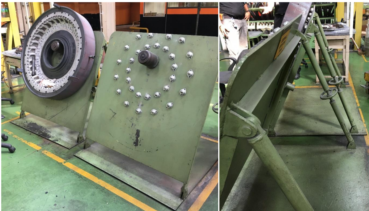
Figura 10.3 – Dispositivo utilizado na limpeza dos minivents na fábrica da Malásia: vista frontal (esquerda) e vista posterior (direita).
