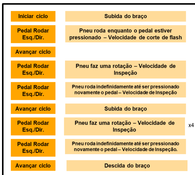
Figura 6.1 - Forma de comando e etapas programadas na Inspectomat para a realização da Inspeção Visual dos pneus agrícolas.
