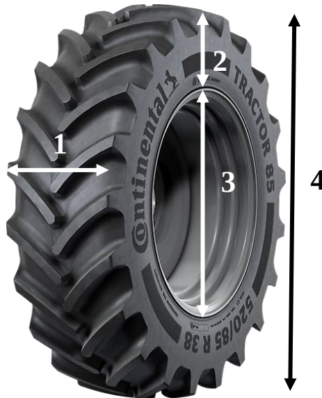
Figura 3.7 - Identificação das dimensões principais de um pneu agrícola (adaptado de [18]).
