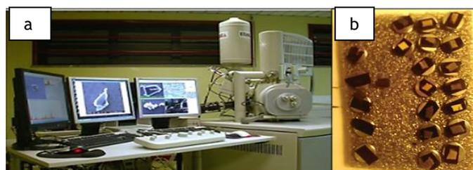
Figura 3.8 - Aparelho de SEM (a) e suporte com as amostras de fratura e superfície analisadas (b)
