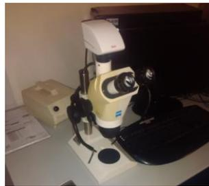
Figura 3.7 - Lupa utilizada na análise macroestrutural.
