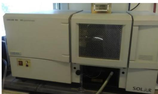
Figura A.12 - Espectrómetro de absorção atómica UNICAM 969.
