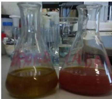
Figura A.6 - Amostra e o branco após o ensaio de titulação.
