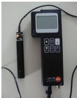
**Figura A.5** - Medidor de condutividade Testo 252.
