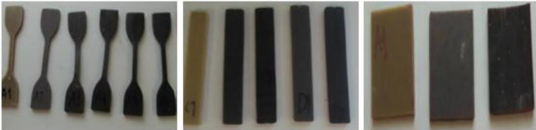
**Figura 3.9** - Provetes utilizados nos ensaios: provetes de tração (esq.); provetes de rasgamento (centro); provetes de dureza *Shore D* (dir.).
