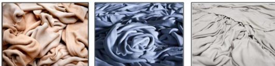
Figura 2.4 - Tipos de curtume em função do agente de curtume utilizado; couro vegetalizado (esq.) [20], couro *wet-blue* (centro) [21], couro *wet-white* (dir.) [21].
