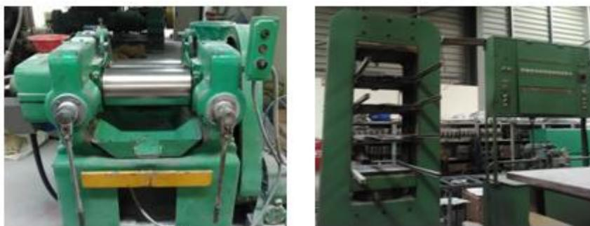
**Figura 3.5** - Misturador de rolos (Esq.) e prensa hidráulica (dir.) utilizados no processamento dos compósitos.
