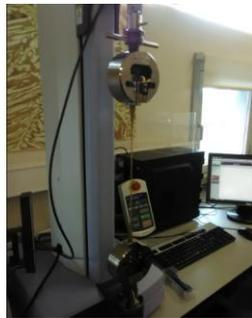
Figura B.1 - Dinamómetro de tração Shimadzu.
