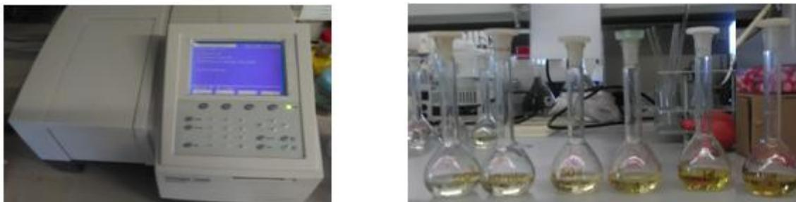
Figura A.7 - Espectrofotômetro UVmini-1240 (esq.), soluções padrão e amostras utilizadas na determinação de nitratos (dir.).
