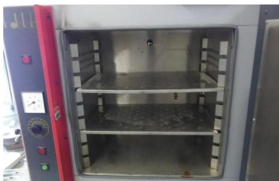
Figura A.1 - Estufa utilizada na secagem das amostras de couro.
