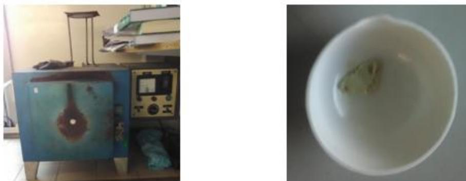
Figura A.9 - Mufla utilizada no ensaio (esq.) e amostra após calcinação (dir.).
