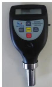
Figura B.2 - Equipamento de dureza Shore D Sauter HDD 100-1
