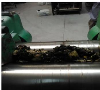
Figura F.1 - Etapa de mistura da pasta de couro na SBR no misturador de rolos laboratorial.
