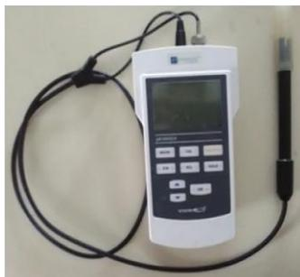
**Figura A.4** - Medidor de pH VWR pHenomenal.
