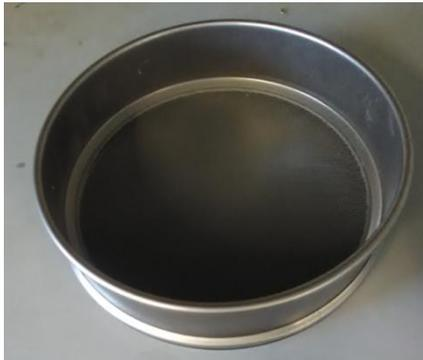
Figura 3.4 - Exemplo de peneiro utilizado na determinação da granulometria do couro.
