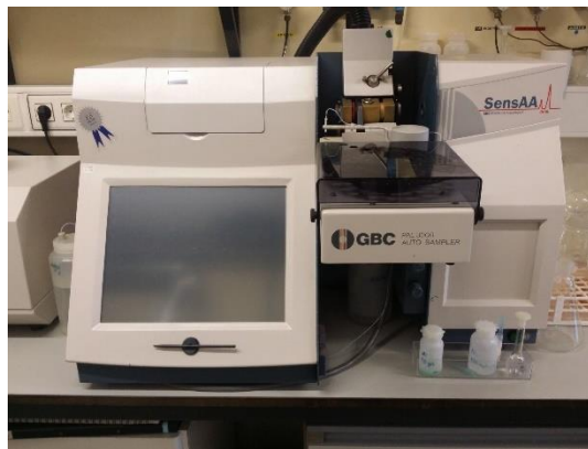
Figura 17– Espectrofotômetro de Absorção atômica, com atomização em câmara de grafite
