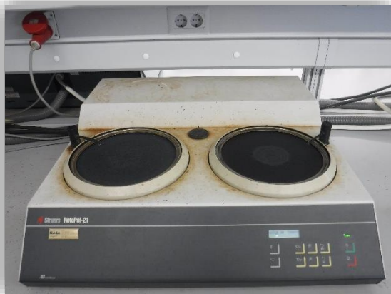
Figura 48 - Equipamento RotoPol -21 da Struers, presente no laboratório de metalografia do DEMec
