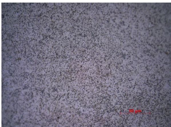
Figura 59 - Amostra 4116 N, aço AISI 440 C (54 HRC) Picral. Microestrutura composta por martensite revenida e carbonetos finos
