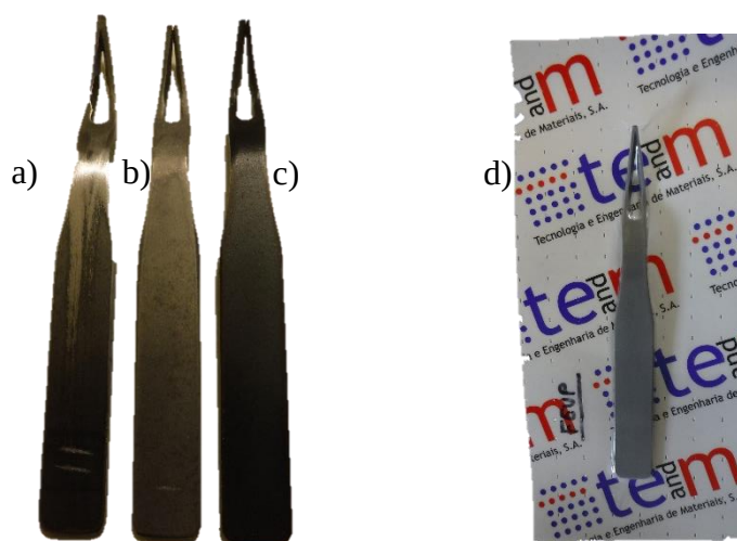
Figura 56 - Ferramentas utilizadas no estudo da influência da nitruração e revestimentos superficiais. a) C45E b) Nitrurada c) PTFE d) V+PVD.
