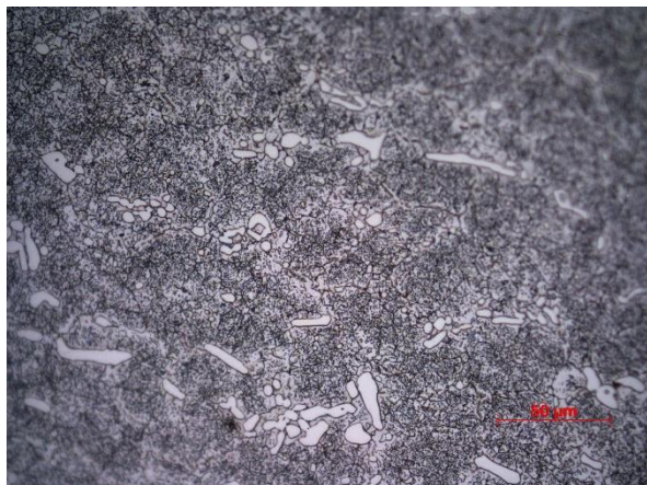
Figura 65- Aço AISI D2). Nital 2%. Microestrutura constituída por carbonetos finos e grosseiros numa matriz martensítica (64HRC).
