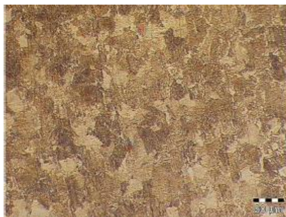
Figura 39 - Amostra NC após o ataque químico. Nital 2%
