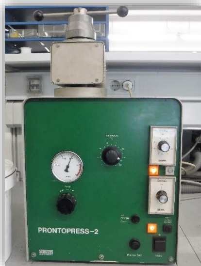
Figura 50 - Máquina Prontopress-2 da Struers presente no laboratório de metalografia do DEMec.
