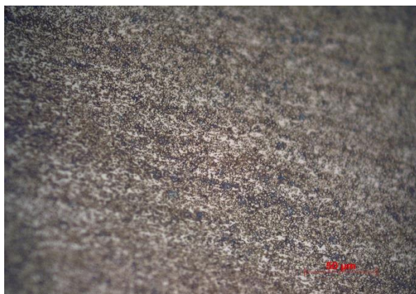
Figura 63 - Aço “Vanadis 8”. Nital 2%. Nesta microestrutura observam-se carbonetos finos distribuídos na matriz ferrítica (218 HB).
