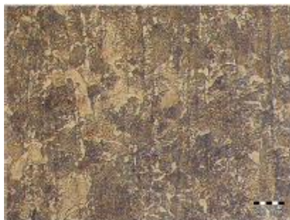
Figura 43 - Amostra DC após o ataque químico. Nital 2%
