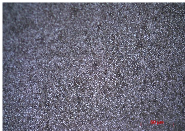
Figura 64 - Aço “Vanadis 8”. Nital 2%. Microestrutura composta por martensite com carbonetos finos e bem distribuídos (63 HRC).
