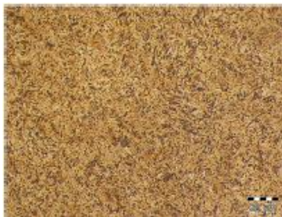
Figura 41 - Amostra DL após o ataque químico. Nital 2%
