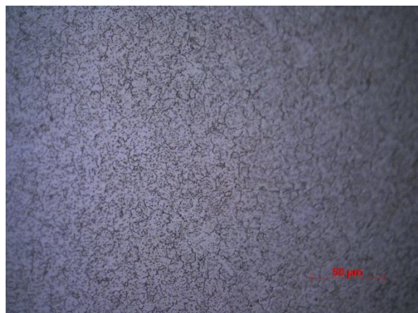
Figura 58- Amostra 4116 L, aço AISI 440C. Picral. Microestrutura é constituída por martensite revenida e carbonetos finos (54 HRC).
