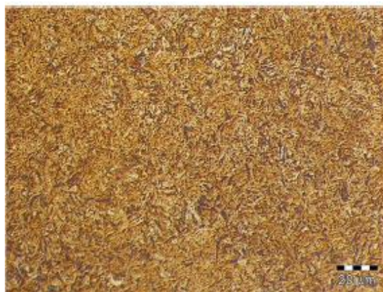
Figura 37 - Amostra NL após o ataque químico. Nital 2%
