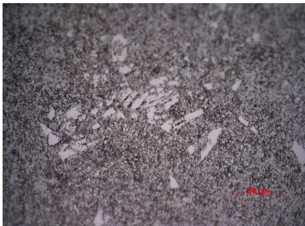
Figura 61 - Aço “Sleipner”, Picral. Microestrutura encontram-se carbonetos possivelmente de crómio, molibdénio e vanádio numa matriz ferrítica (243 HB).
