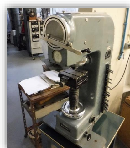
Figura 47 - Durómetro Dia Testor 2 RC presente no laboratório de ensaios tecnológicos do DEMec.
