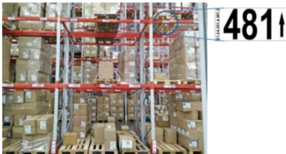
Figura 14 - Estanteria utilizada no armazém e exemplo de um check digit
