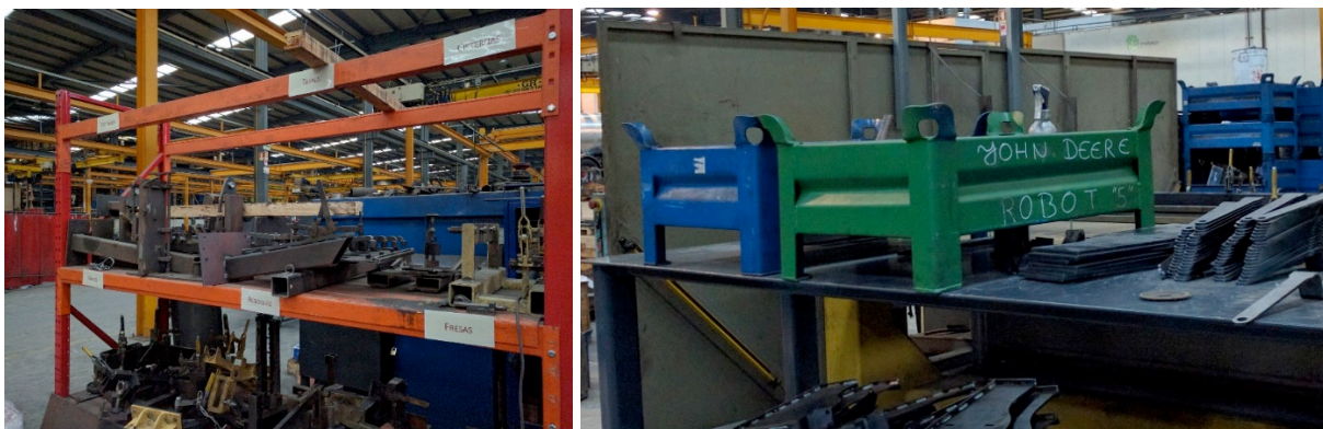
Figura 37 – Estante de Gabaris e Mesa de Abastecimento do Robot 5
