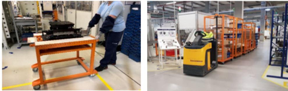
Figura 23 - Movimentação da ferramenta da prensa (Atual Vs. Proposta para futuro)
