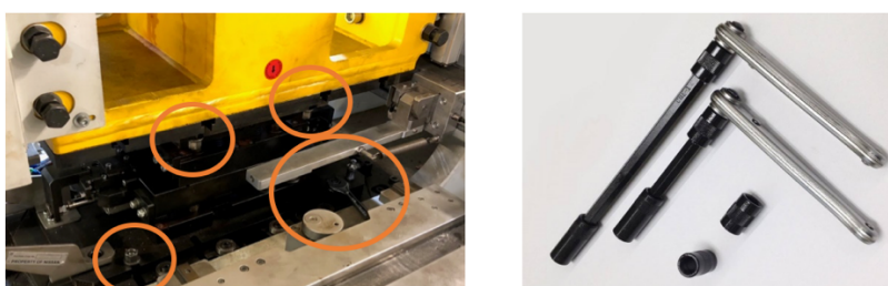
Figura 30 - Fixação da prensa e proposta de chave de roquete com extensão
