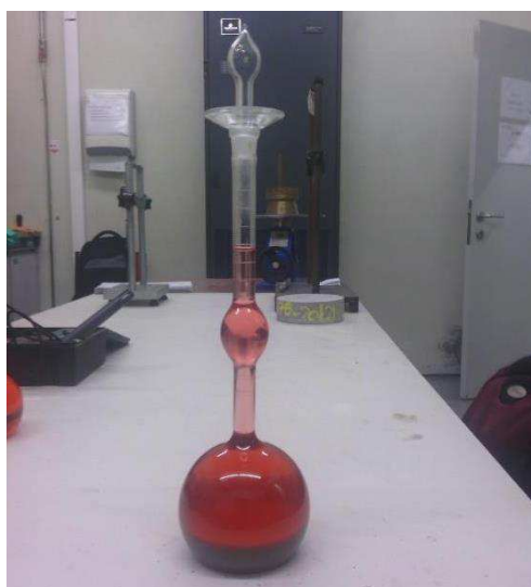
Figura 3.9: Voluminímetro com petróleo e material a estudar
