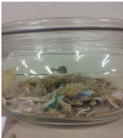
Figura 3.2: Plástico e fibras retidas no peneiro 1mm
