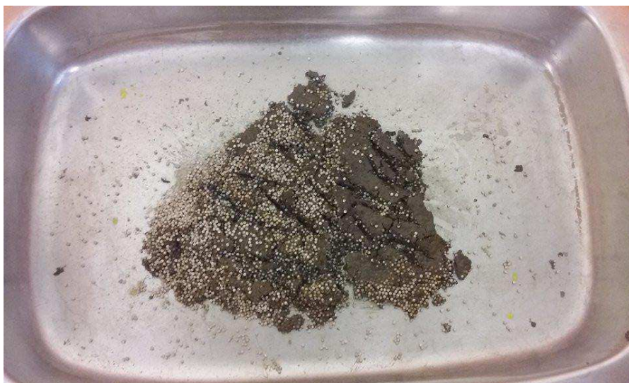
Figura 3.6: GPBA com álcool e esferas de 1mm
