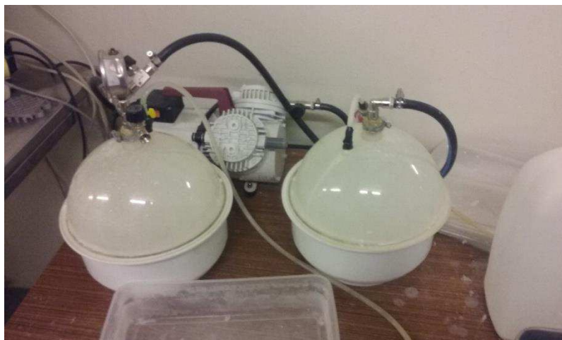
Figura 3.25: Provetes na câmara de vácuo
