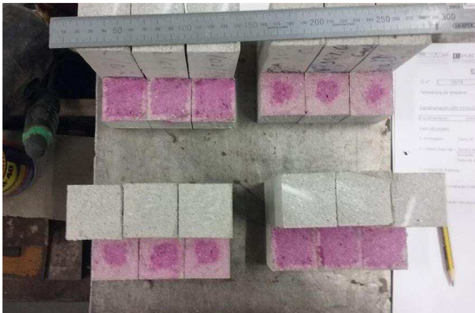
Figura 3.20: Provetes pulverizados por fenolftaleína
