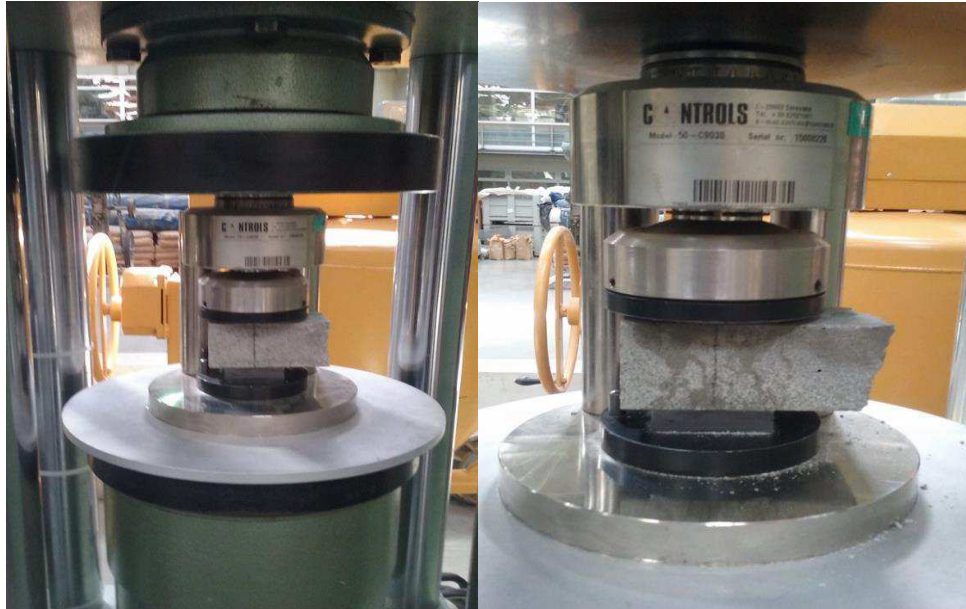
Figura 3.15: Ensaio de resistência à compressão
