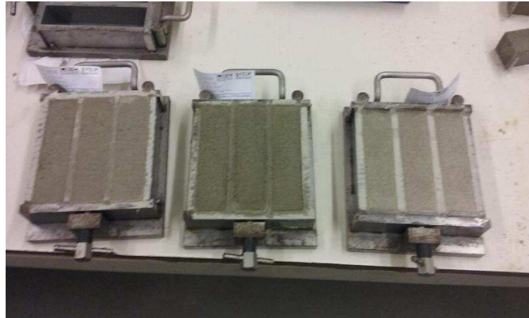
Figura 3.19: Provetes utilizados no ensaio de carbonatação acelerada
