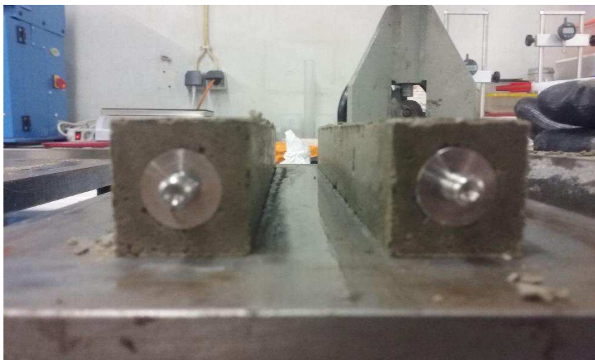
Figura 3.33: Pernos colocados nas extremidades dos provetes
