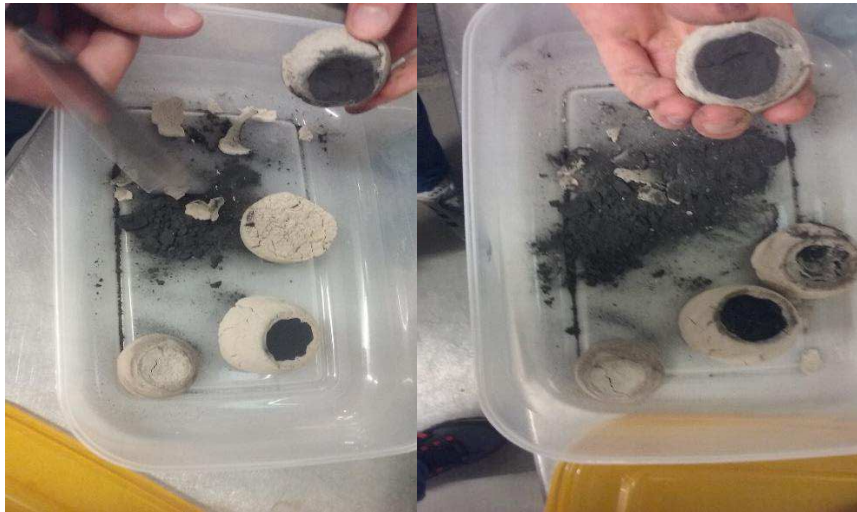
Figura 4.3: Resultado da incineração do material GPBA a uma temperatura de 400°C
