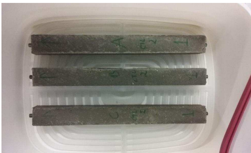
Figura 3.32: Provetes utilizados para avaliar a reação ASR
