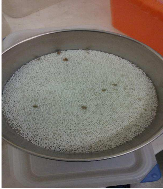
Figura 3.4: Peneiro com esferas de 1mm e com fibras
