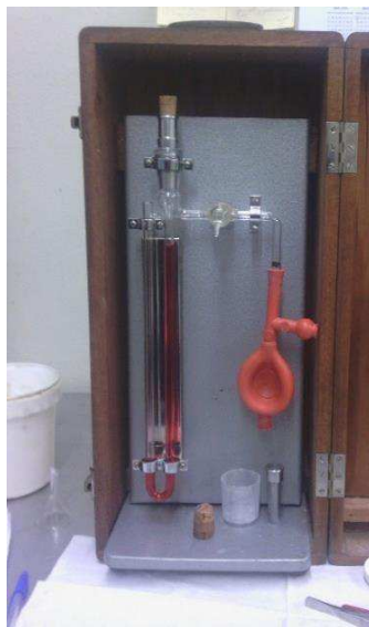
Figura 3.10: Equipamento utilizado no ensaio de Blaine
