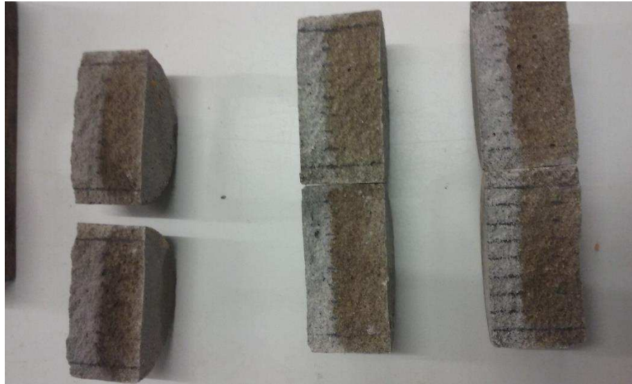
Figura 3.28: Medição da profundidade de penetração de cloretos
