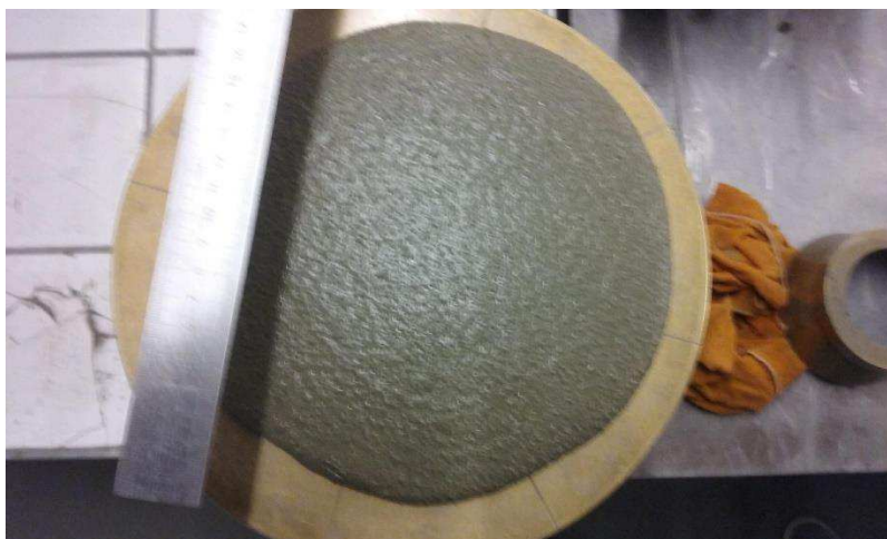
Figura 3.12: Medição dos diâmetros de espalhamento
