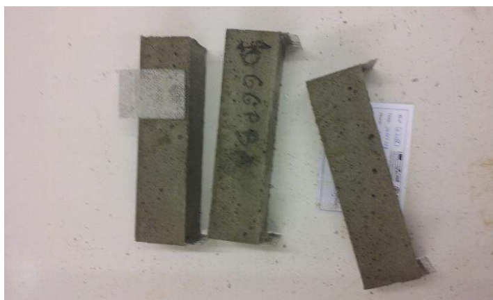
Figura 3.16: Provetes com redes de inox
