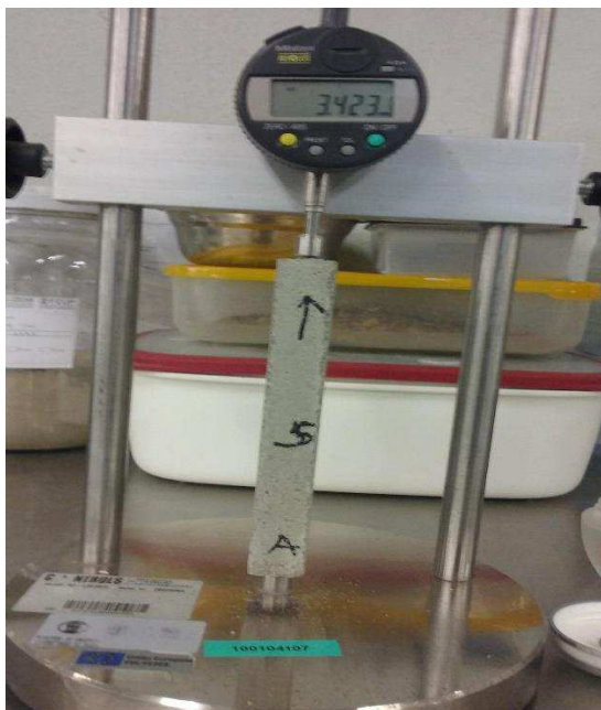
Figura 3.30: Medição da expansão do provete
