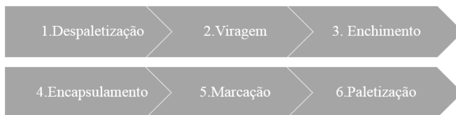
Figura 11 - Esquema do processo produtivo para as linhas de vidro e lata
