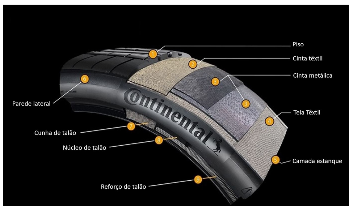
Figura 2.2: Estrutura de um pneu [4] - adaptado
