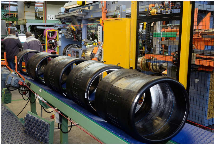
Figura 2.4: Fase de Construção [5]
