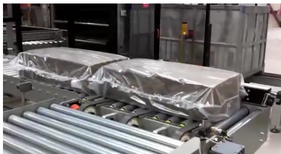
Figura 5.7: Exemplo de crossing conveyor para mudança de direção
