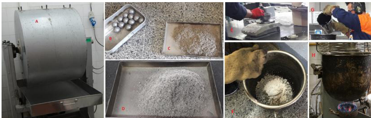
Figura 6. 1 – A) Equipamento do ensaio Los Angeles; B) Esferas metálicas; C) Fibras de celulose revestidas a betume trituradas; D) Fibras de celulose revestidas a cera trituradas; E) Pesagem dos materiais constituintes das misturas; F) Introdução dos materiais no misturador; G) Adição do betume; H) Aquecimento da mistura; [Fonte: Própria]
