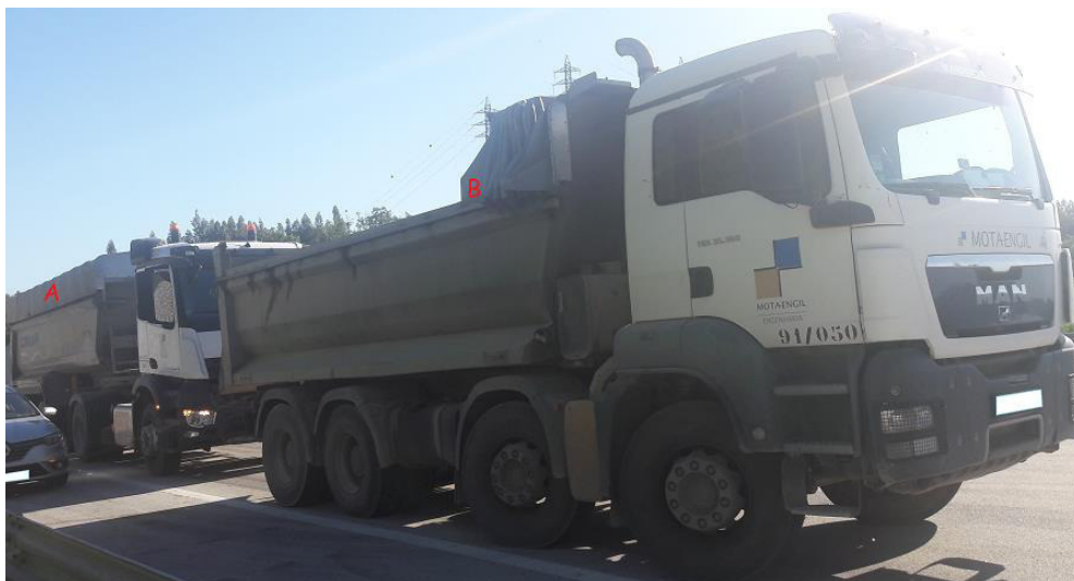
Figura 5. 13 – Camiões com reboques basculantes integrados com tela de cobertura: A) Fechada; B) Aberta; [Fonte: Própria]
