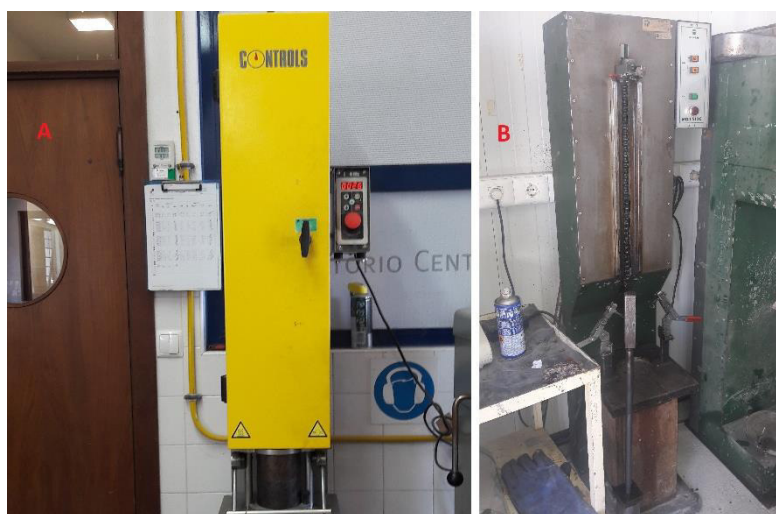
Figura 4. 4 – Compactadores Marshall: A) do Laboratório Central Mota Engil; B) do Laboratório do estaleiro da obra no Passil [Fonte: Própria]
