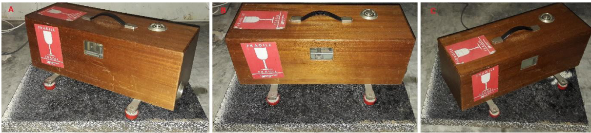
Figura 6. 4 – Máquina de impactos normalizada Brüel & Kjaer na câmara reverberante emissora (piso superior) em diferentes posições: A) Posição 2; B) Posição 3; C) Posição 4; [Fonte: Própria]
