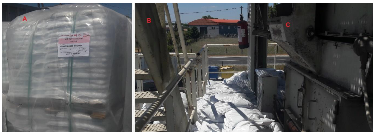
Figura 5. 10 – A) Sacos de fibras termo fundíveis; B) Central do Passil com sacos de fibras; C) Comporta para introdução das fibras no misturador; [Fonte: Própria]
