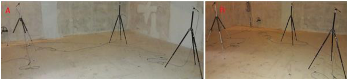
Figura 6. 5 – Microfones na câmara reverberante recetora (piso térreo) em diferentes posições: A) Posição 1; B) Posição 2; [Fonte: Própria]
