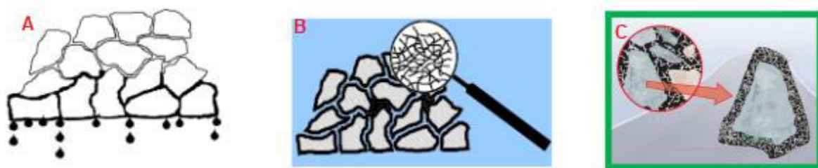
Figura 4. 6 – Misturas betuminosas descontínuas: A) sem fibras; B) e C) com fibras [Fonte: Martinho et al. (2013)]
