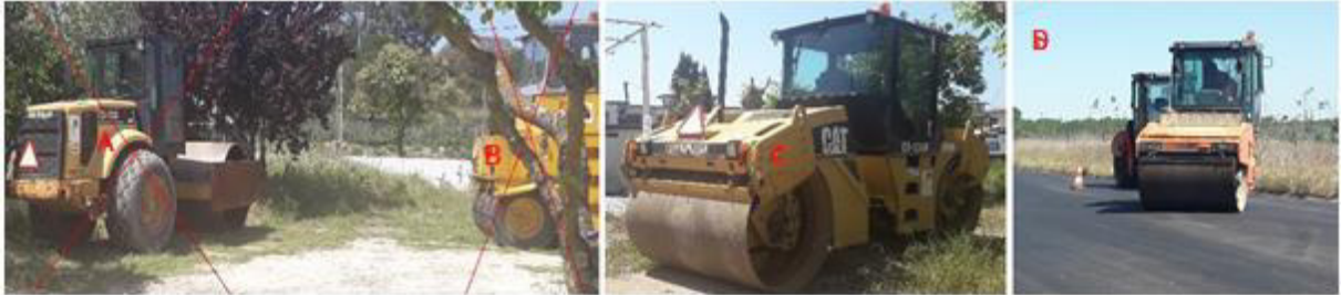
Figura 5. 16 – Cilindros não utilizados na compactação de misturas SMA: A) misto; B) de pneus; Cilindros de rolos utilizados na compactação de SMA: C) Caterpillar CB-534D; D) HAMM HD90; [Fonte: Própria]
