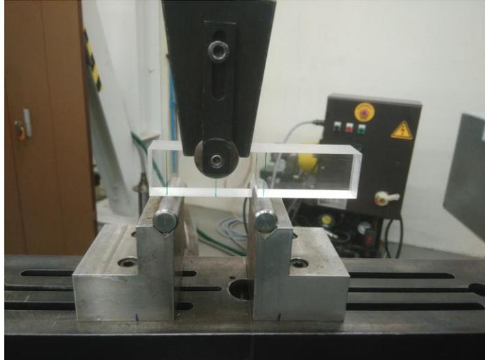
Figura 80 - Montagem para o ensaio de flexão em 3 pontos, modo misto.
