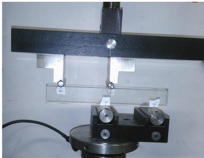
Figura 123 – Montagem experimental do provete 1 com carga assimétrica (modo II puro).
