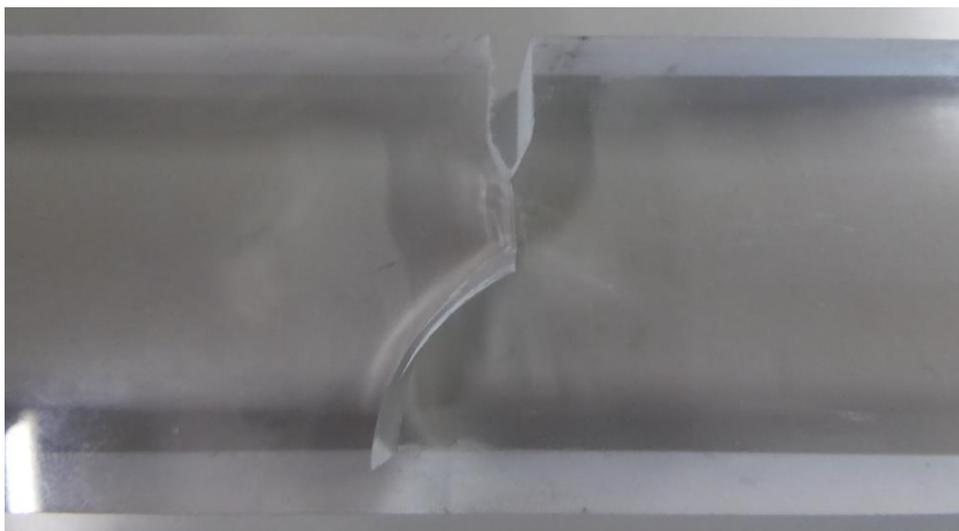
Figura 124 - Propagação da fenda, provete 1.
