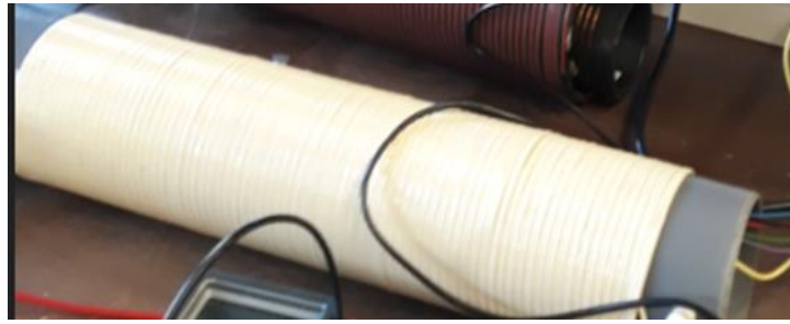
Figura 2. Solenoide construído para a experiência da lei de indução.
