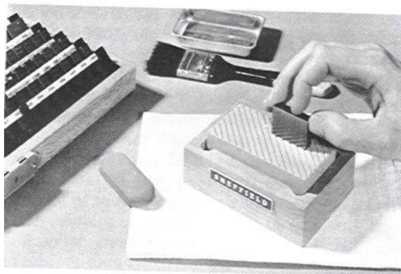
Figura 2.3 – Utilização de pedra de “Arkansas” para remover pequenos defeitos
