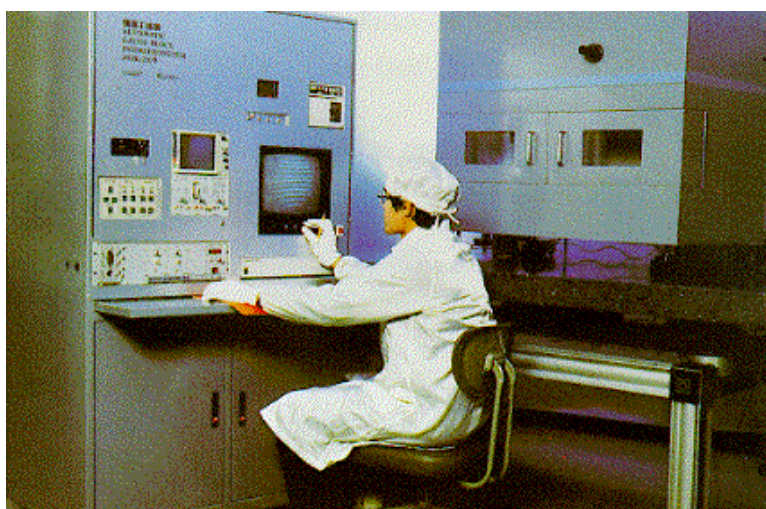
Figura 1.3 – Sistema baseado no método absoluto: interferómetro LASER
