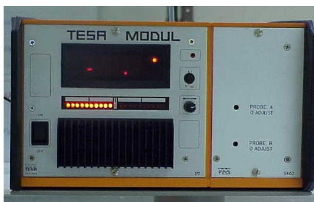
Figura 2.17 – Dispositivo indicador da unidade de medição TESAMODUL
