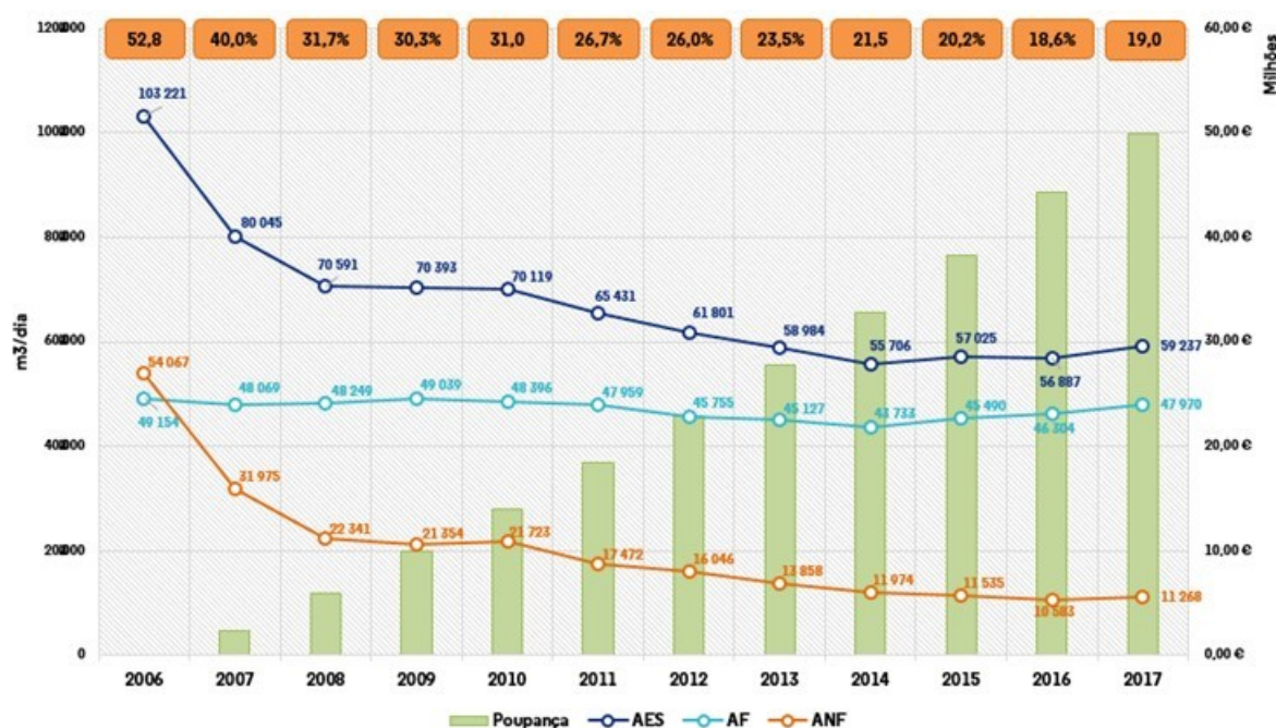
Figura 10 – Evolução da Água Entrada no Sistema (AES, Água Faturada (AF), Água Não Faturada (ANF) e da poupança acumulada entre 2006 e 2017 (Águas do Porto, 2018)
