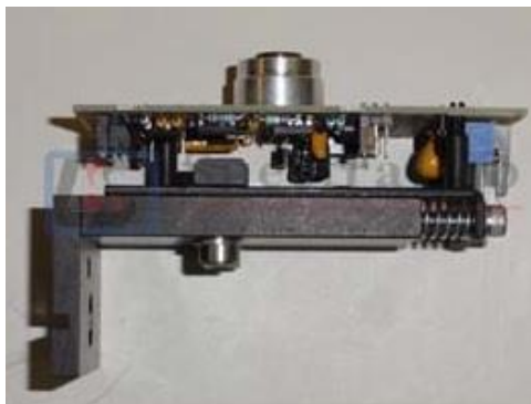
Fig. 30. Exemplo de um detetor DTGS para FTIR na região “mid-IR”. [72]
