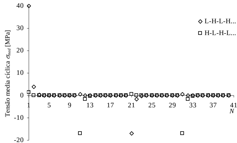
Figura 6.14 – Tensão média cíclica versus ciclos resultante de um carregamento definido por blocos de amplitude constante aplicados segundo as sequências L-H-L-H... e H-L-L-H... com gamas de deformação de 0.75 e 1.5%, respectivamente.
