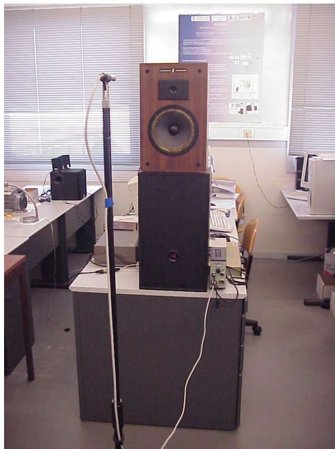
Figura C2 – Fotografia do sistema altifalante utilizado na avaliação experimental da igualização de respostas electroacústicas
