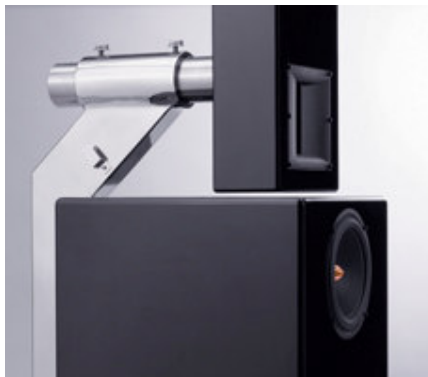
Figura 2.21 – Sistema altifalante com possibilidade de deslocamento do radiador de altas frequências para efeitos de alinhamento temporal do conjunto
