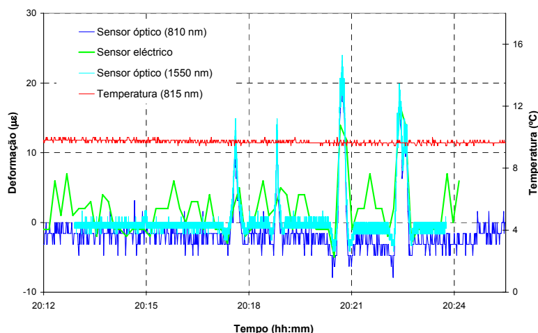
Figura 7.39 Resultados gráficos de deformação: ensaio dinâmico – passagens com ressalto. Comparação entre os três sistemas de monitorização
