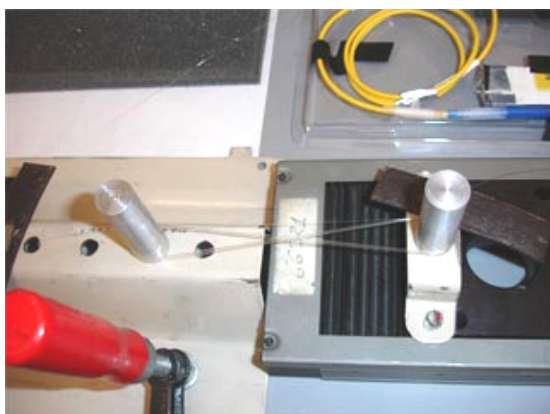
Figura 5.14 Fotografias do dispositivo de varrimento dos estados de polarização
