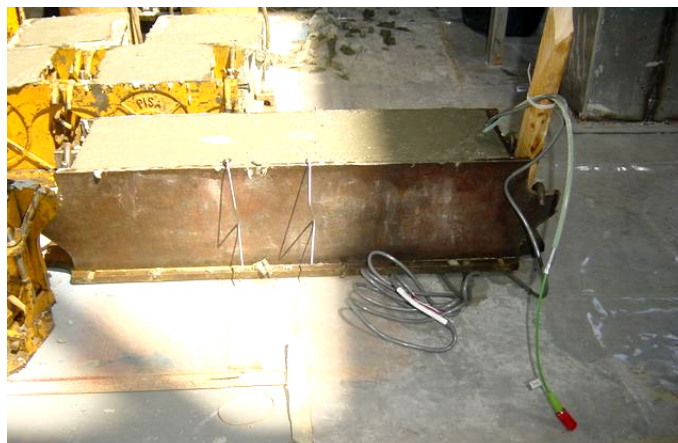
Figura 4.28 Imagem de um Prisma, após a betonagem e em período de secagem
