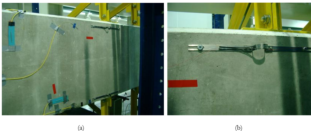
Figura 7.8 Fotografias de dois transdutores tipo “clip”, instalados na secção central traseira de um dos degraus da bancada
