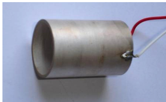
Figura 5.23 Fotografia do tubo cerâmico piezoeléctrico após a soldagem das ligações eléctricas
