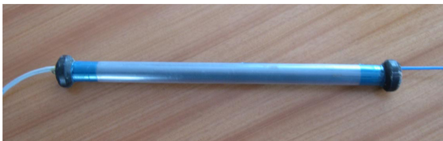
Figura 7.26 Imagem de uma cabeça sensora antes de instalada em obra
