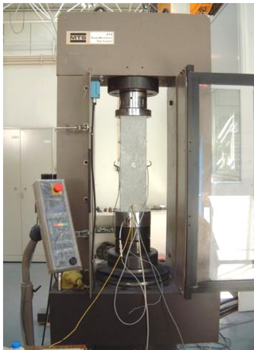
Figura 4.31 Prensa utilizada para a aplicação de compressão ao prisma de betão
