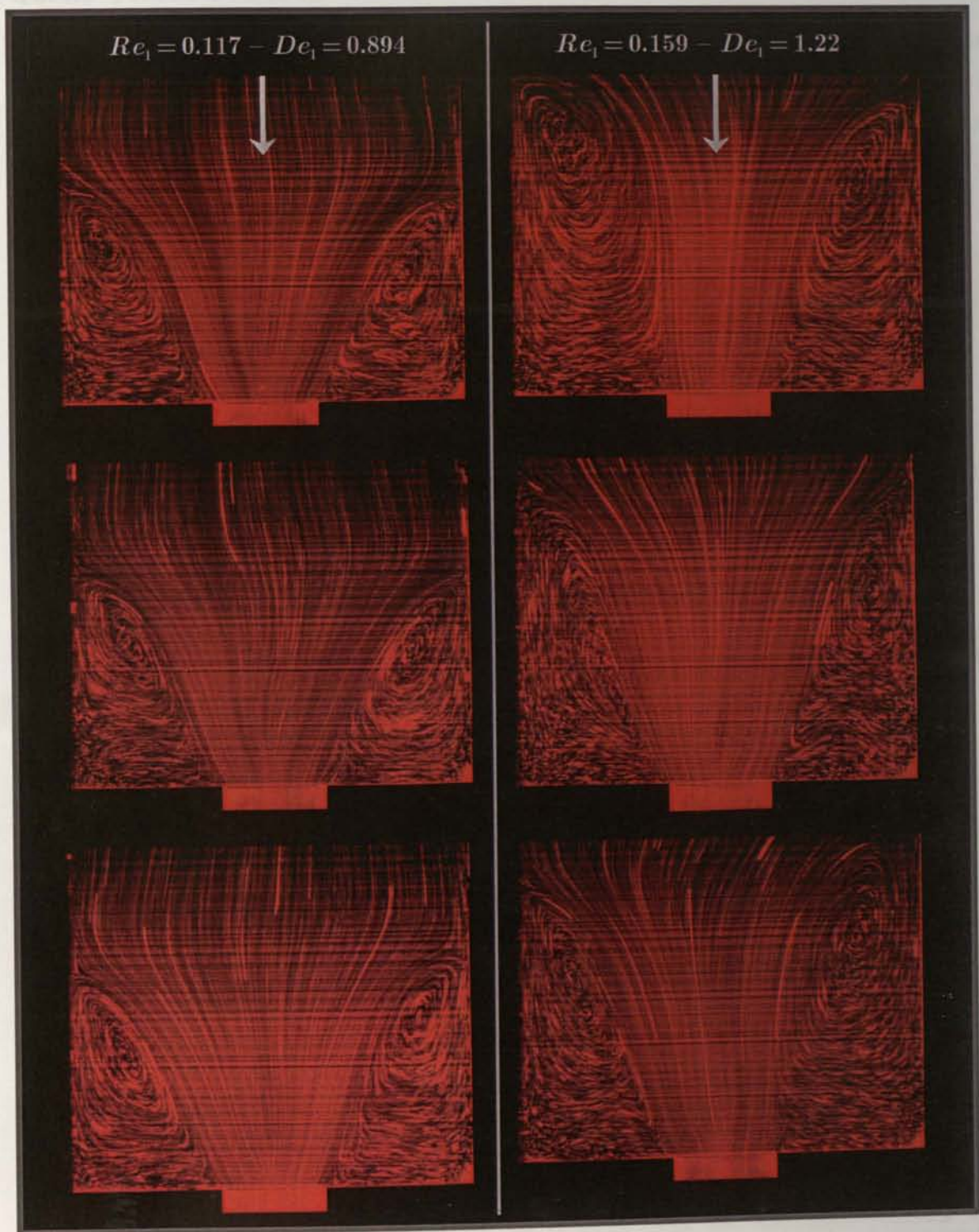
Figura 10.33: Linhas de rasto observadas experimentalmente com o fluido PAA100 no plano central da contração 4:1 em condições de escoamento variável. Ilustração de três fases do ciclo de oscilação do escoamento. As visualizações decorreram à temperatura de 18.1 °C.
