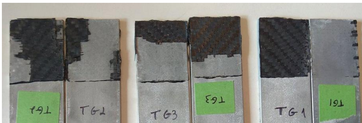
Figura 102 - Provete do tipo TG após ensaio de tração.
