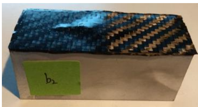
Figura 106 - Aspeto após ensaio dos provetes do tipo b.
