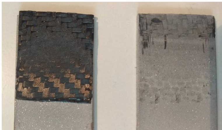
Figura 84 - Provete do tipo TA após ensaio de tração.
