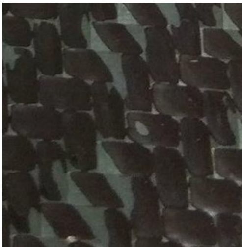
Figura 46 - Pré-impregnado utilizado, sendo visível o tecido fibroso na forma Twill .
