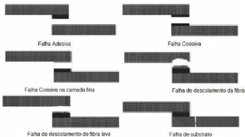
Figura 29 - Falhas na adesão de materiais compósitos.[45]
