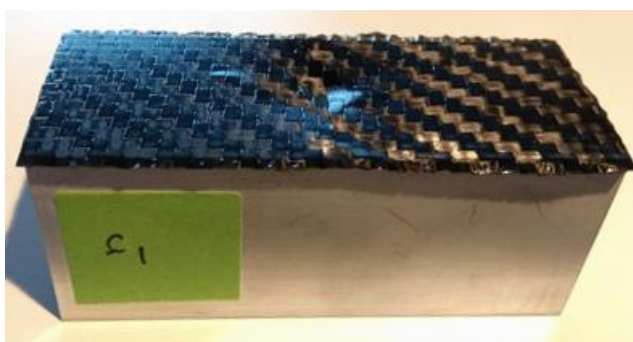
Figura 108 - Aspeto após ensaio dos provetes do tipo c.
