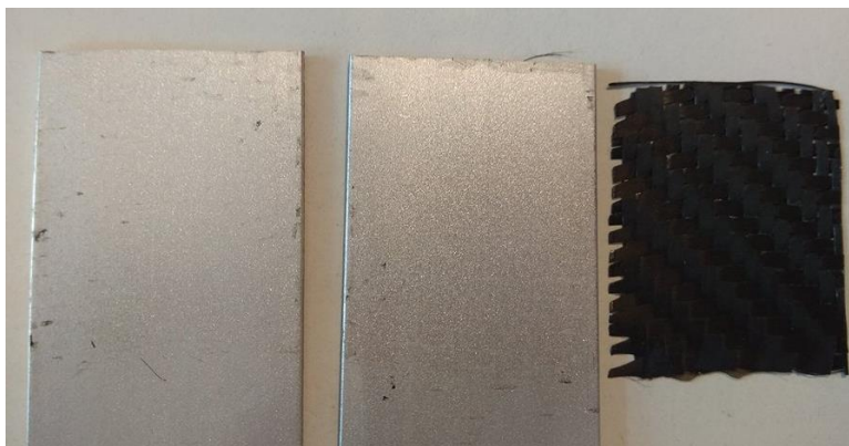
Figura 96 - Provete do tipo TE após ensaio de tração.
