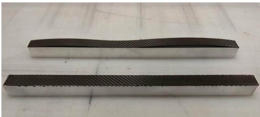
Figura 52 - Híbrido com adesão conseguida (frente), e híbrido não aderido (atrás).
