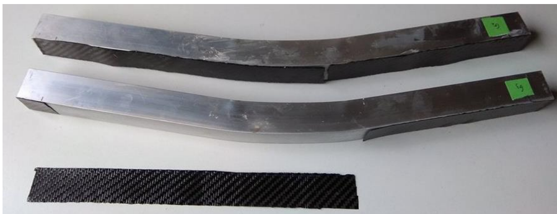
Figura 80 - Provete G2 (acima) com falha adesiva local e provete G3 (abaixo) com falha adesiva segundo um elevado comprimento.
