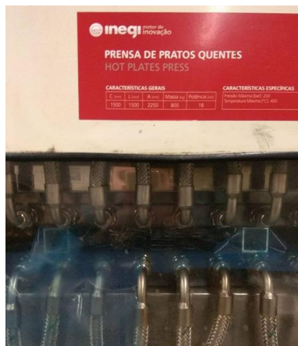
Figura 50 – Processo de cura e arrefecimento levado a cabo na prensa de pratos quentes.
