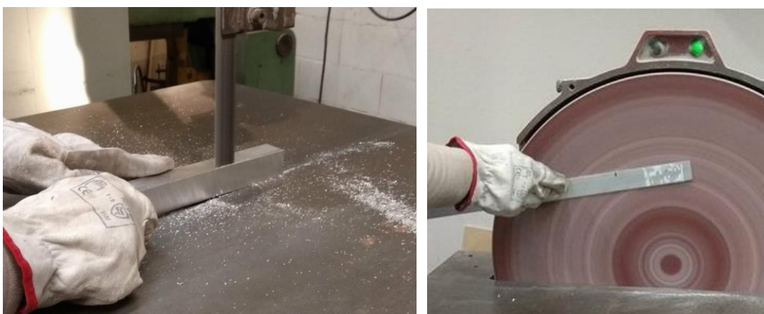
Figura 59 - Processo de corte (esq.) e lixagem (dir.) dos perfis de modo a produzir os substratos.
