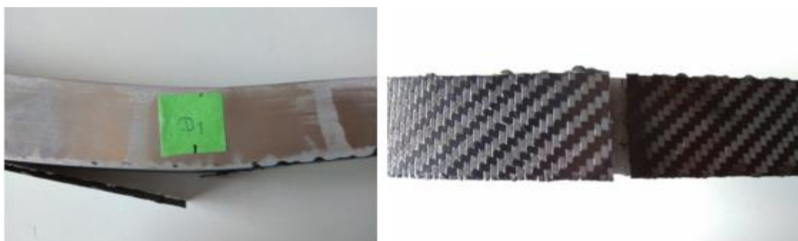
Figura 74 - Vista em pormenor da falha adesiva e rotura das fibras de um provete de flexão tipo D.
