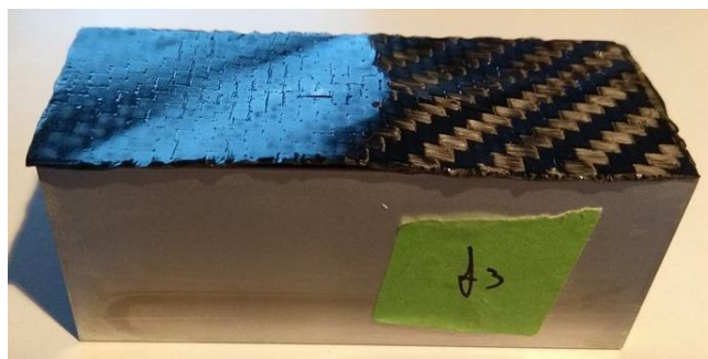
Figura 114 - Aspecto após ensaio dos provetes do tipo f.
