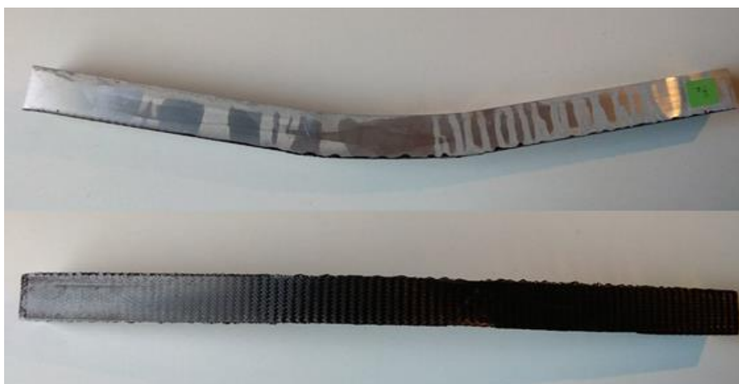
Figura 82 – Aspecto final do provete H2, verificando-se a integridade do mesmo após ensaio.
