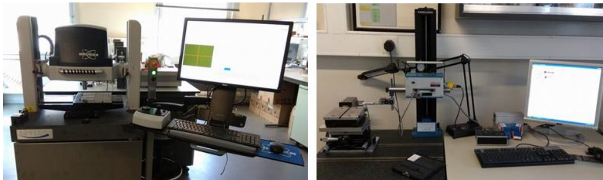
Figura 65 – Instrumento de metrologia ótica Bruker NpFlex (esq.) e rugosímetro HommelWerke LV-50.
