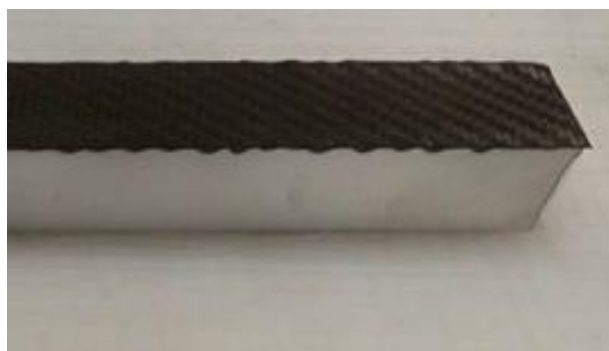
Figura 53 - Perfil híbrido com apenas uma camada de pré-impregnado.
