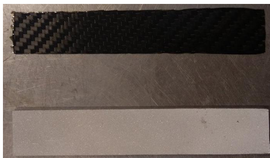
Figura 64 - Aspeto dos provetes utilizados no ensaio de corrosão galvânica.
