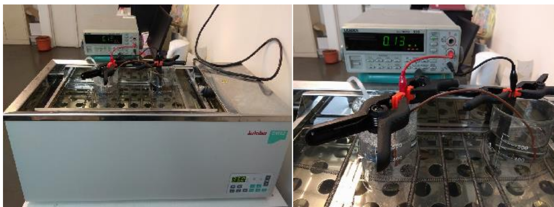
Figura 63 - Apresentação geral e em pormenor do ensaio de corrosão galvânica.
