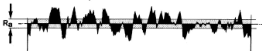
Figura 66 - Representação esquemática do parâmetro R_a . [53]
