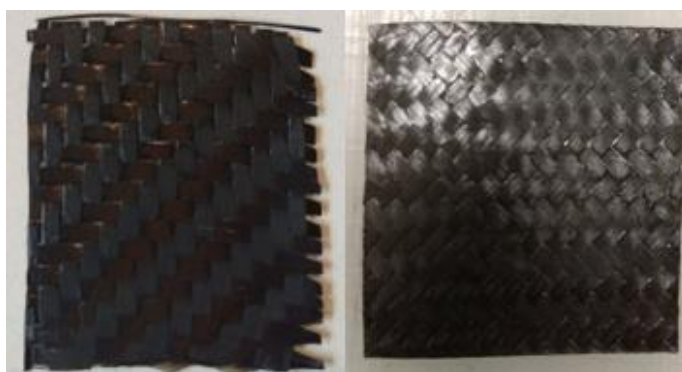
Figura 57 - Provete G e H, relativos ao pré-impregnado não curado(dir.) e curado (esq.).
