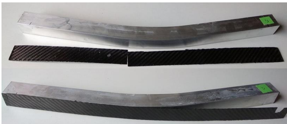
Figura 78 - Aspeto dos provetes F3 (acima) e F2 (abaixo) após ensaio onde se verifica uma peruma falha adesiva total e quase total, respetivamente.
