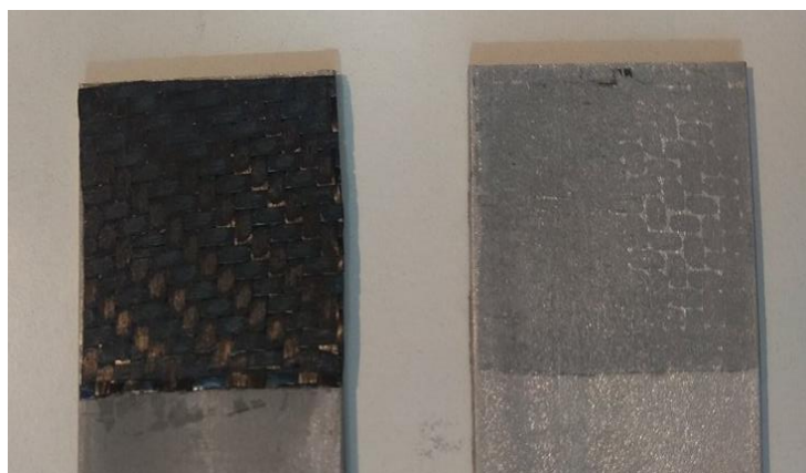
Figura 87 - Provede do tipo TB após ensaio de tração.
