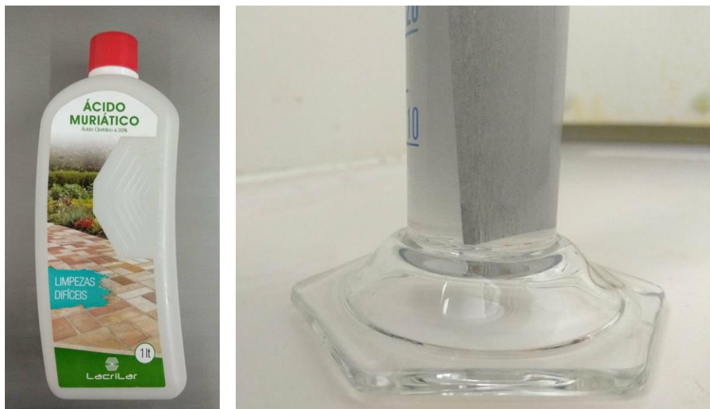
Figura 49 - Ácido muriático utilizado (esq.) e aspecto da reação do mesmo com o alumínio (dir.).
