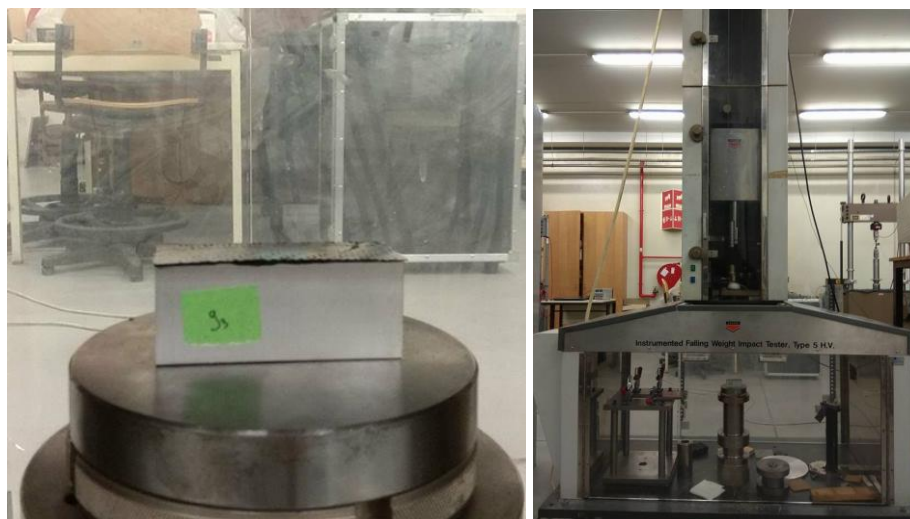
Figura 62 – Provete para ensaio de impacto (esq.) e máquina de ensaio por queda livre de peso (dir.).
