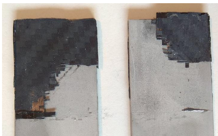
Figura 99 - Provede do tipo TF após ensaio de tração.
