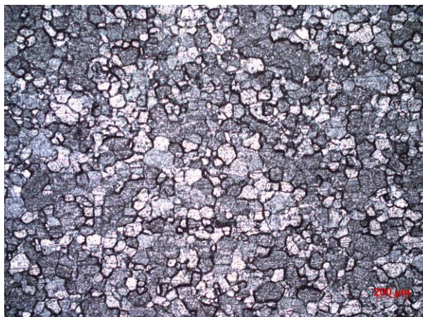
Figura 97 - Aspeto microscópico de um substrato do tipo TE após ensaio de tração.
