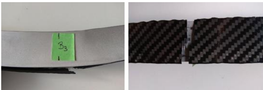
Figura 70 - Vista em pormenor da falha adesiva e rotura das fibras de um provete de flexão tipo B.
