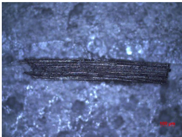
Figura 103 - Aspecto microscópico de um substrato do tipo TG após ensaio de tração.
