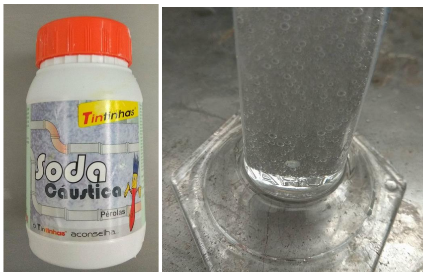
Figura 48 - Hidróxido de sódio utilizado (esq.) e aspeto da reação do mesmo com o alumínio (dir.).
