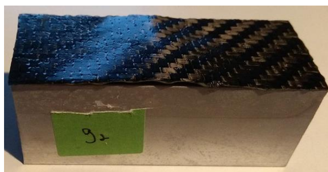
Figura 116 - Aspeto após ensaio dos provetes do tipo g.
