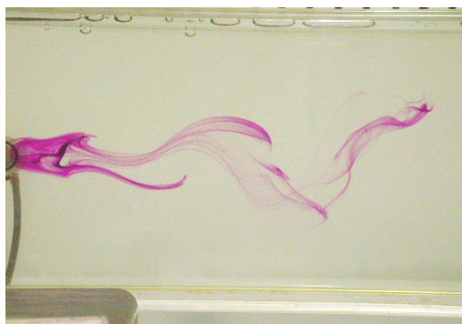
Figura 4-11 Ejeção de vórtices, (solução 0,03% PAA, Re^* = 136 , D = 20 mm),
