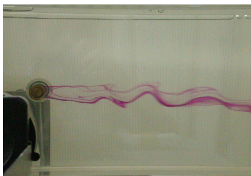
Figura 4-9 Ausência de ejeção de vórtices, (solução 0,03% PAA, Re^* = 752 , D = 10 mm).
