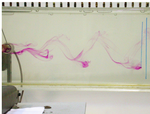
Figura 4-7 Limites da esteira (solução 0,02% PAA, Re^* = 145 , D = 20 mm).
