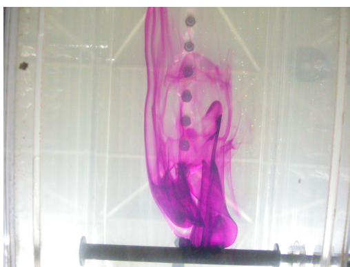
Figura 4-10 Visualização da dispersão tridimensional, quando a turbulência está presente (solução 0,03% PAA, D = 10 mm).
