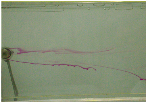
Figura 4-6 Sem ejeção de vórtices: notar o efeito da densidade do traçador (solução 0,02% PAA, Re^* = 66 , D = 20 mm).
