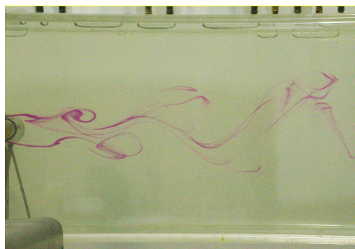
Figura 4-4 Ejeção laminar de vórtices (solução 0,02% PAA, Re^* = 247 , D = 20 mm).
