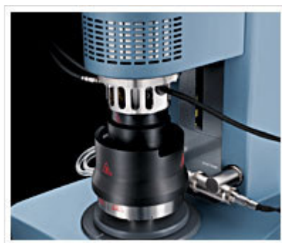
Figura 2-7 Reómetro TA- AR 2000, esquema do sistema de medida utilizado, geometria de cone e prato (40 mm, 2^\circ ), com sistema de controle de temperatura incorporado (UHP).
