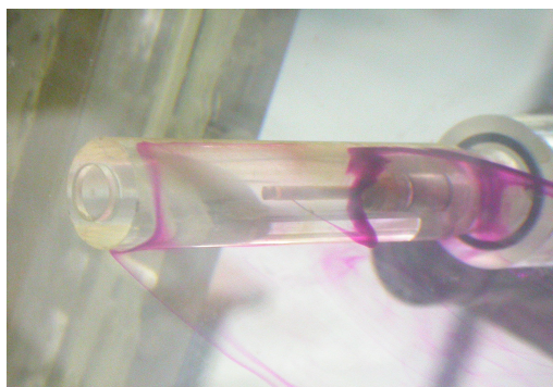
Figura 4-8 Pormenor da dispersão do traçador em torno do cilindro (solução 0,01% PAA, D = 20 mm).
