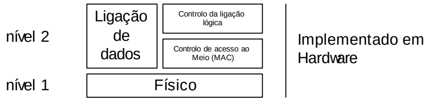
Figura 4.11: Camadas OSI implementadas pelo CAN
