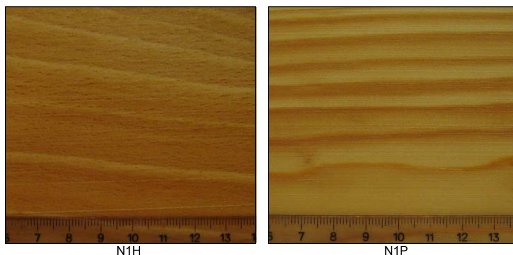
Figure IV.12 - Surface de hêtre (H) et du pin (P), avec l'usinage au niveau 1 (N1)
