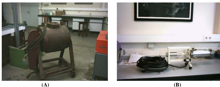
Figura 6.2 - Aspecto do tambor (A) e extrusor (B) utilizado no processo de preparação dos peletes
