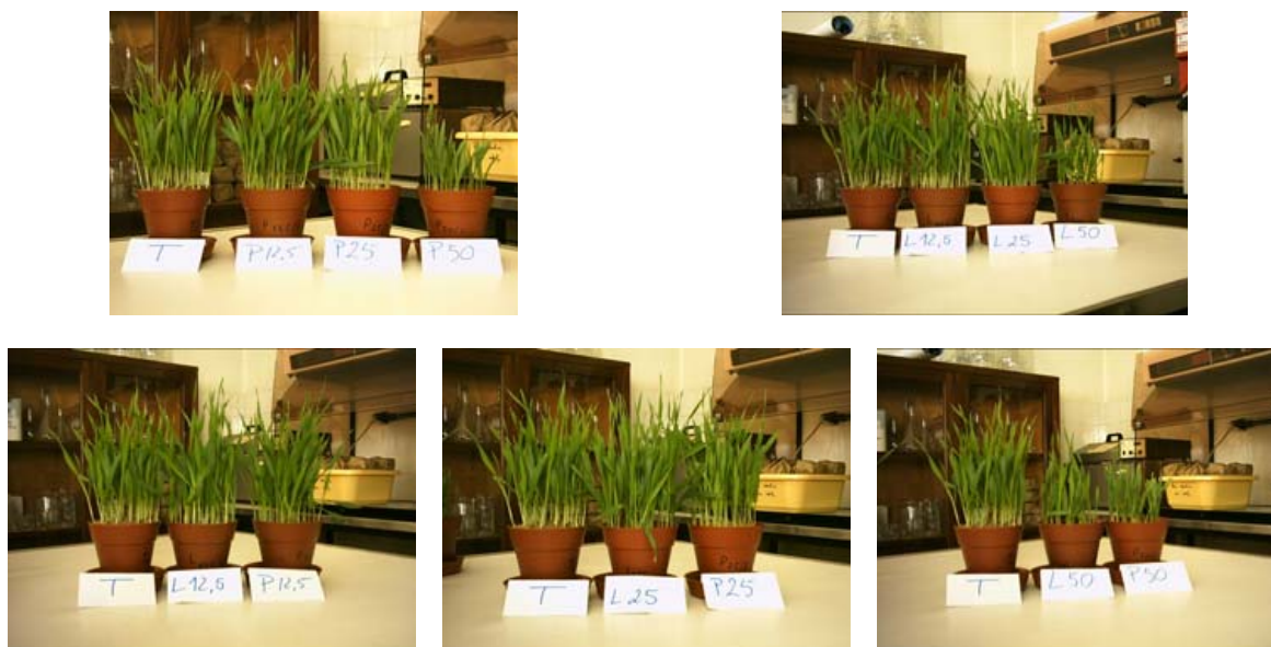
Figura 7.4 - Ensaio de produção de biomassa com cevada para os produtos: Peletes (P) e Lama (L) e a modalidade testemunha. Nas fotografias da parte superior, da esquerda para a direita, encontram-se os vasos da testemunha (T) seguido do vaso com 12,5% de volume de substrato (P/L 12,5), seguido do vaso com 25% de volume de substrato (P/L 25) e por fim o vaso com 50% de volume de substrato (P/L 50). Nas fotografias da parte inferior, encontram-se os vasos para cada uma das proporções (12,5; 25% e 50%), demonstrando as principais diferenças entre os produtos testados (peletes e lama) e a testemunha
