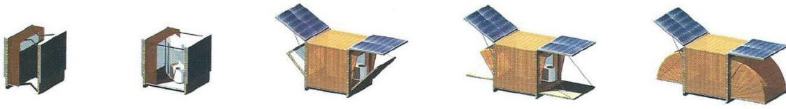
i.48. Translação dos dois blocos fixos e rebatimento do pavimento para a posição final.
