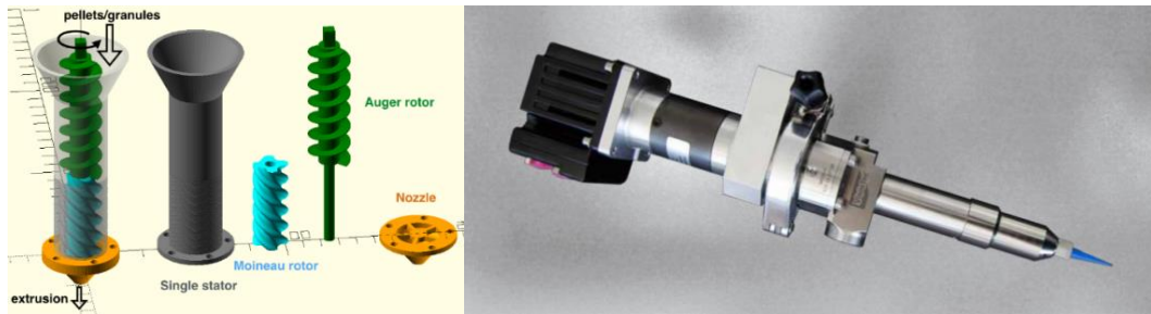
Figura 59: A esquerda o conceito de extrusão com bomba de Moineau com alimentação assistida por uma broca Auger (Journal of Brief Ideas 2018) e a direita, o extrusor do tipo Moineau da ViscoTec (ViscoTec 2018).
