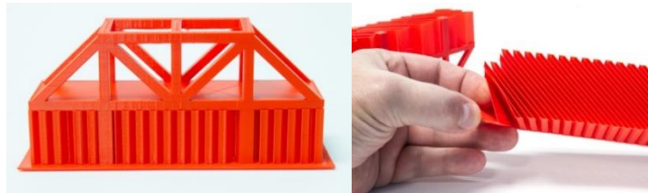
Figura 34: Exemplo da utilização de material suporte. (Matterhackers 2018)
