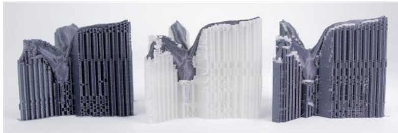
Figura 38: 1 - Suporte convencional (mesmo material do objeto, ineficiente); 2 - Suporte 100% PVA (dispendioso); 3 - Suporte composto maioritariamente do mesmo material do objeto com apenas a superfície de contacto com o objeto sendo feita de PVA (eficiente). (3ders.org 2018b)
