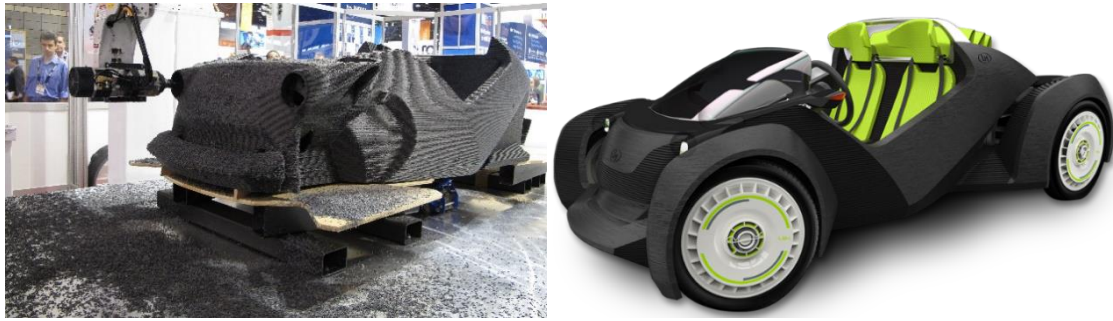
Figura 42: Primeiro carro com carroçaria monobloco totalmente fabricado com impressão 3D. (Business Wire 2018), (LM labs 2018)
