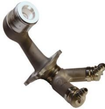
Figura 16: Novo injetor de combustível para motores a jato, desenvolvido pela GE e Safran. (3D hubs 2018a)
