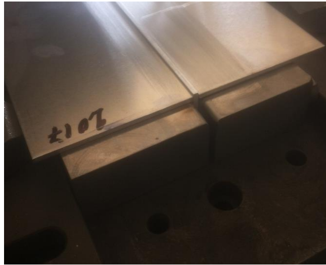
Figura 3.2 - Montagem das chapas na fresadora convencional
