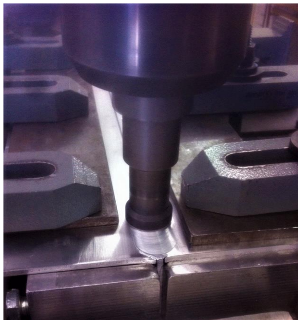
Figura 3.3 - Execução das soldaduras
