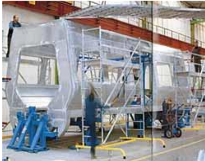
Figura 2.22 - Carruagem de comboio soldada por FSW [49]
