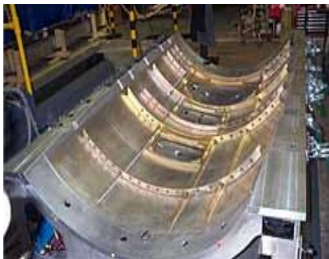
Figura 2.21 - Painel lateral de cockpit soldado por FSW [49]
