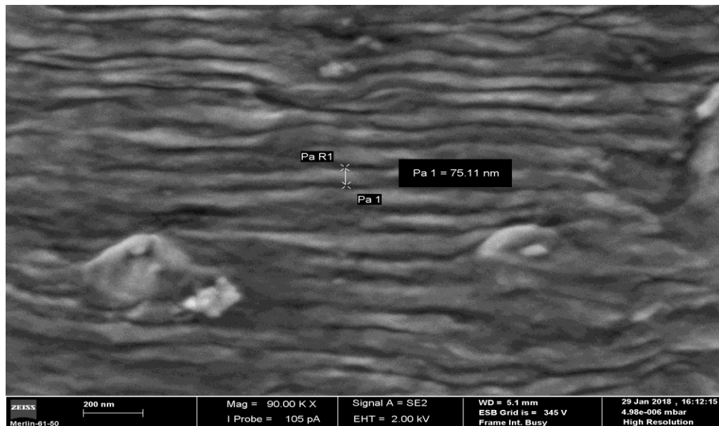
Figura 4.29 – Fratura por fadiga PP1 a) aos 631.603 ciclos fadiga; gama tensão aplicada: 99 MPa
