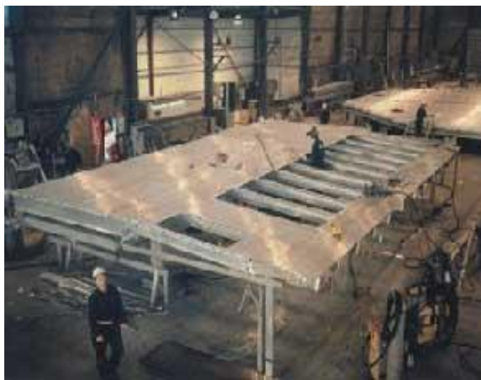
Figura 2.20 - Painel lateral de catamarã soldado por FSW [58]
