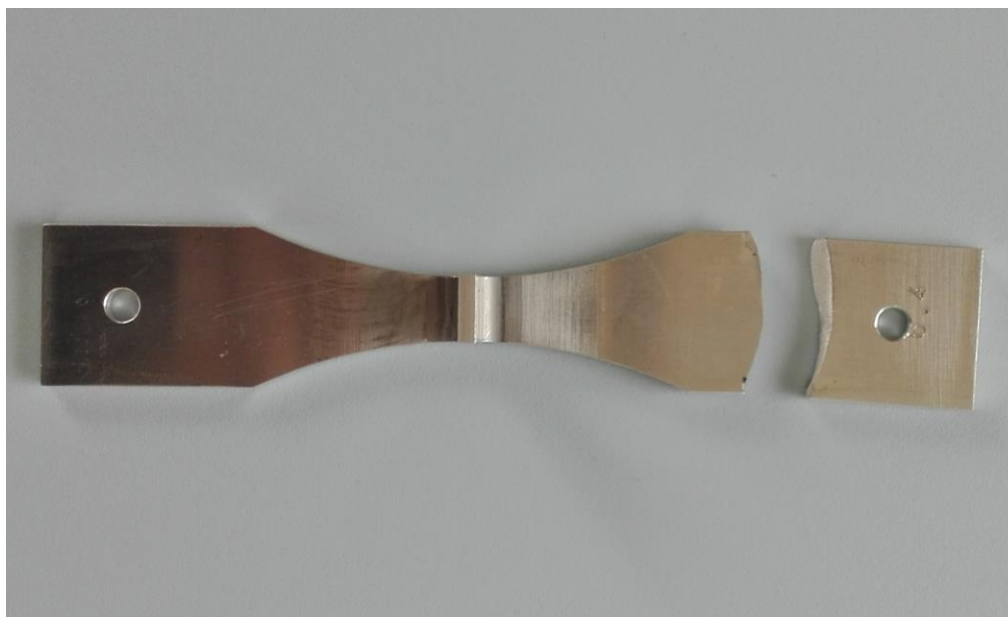
Figura 4.20 - Provete de fadiga fraturado na zona da amarra
