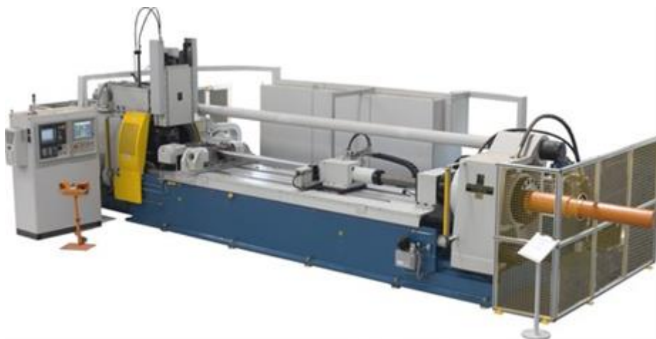
Figura 2.23 – Esquema de equipamento utilizado no processo FSW [59]
