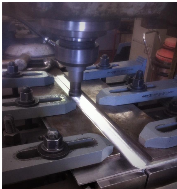
Figura 3.4 - Execução das soldaduras
