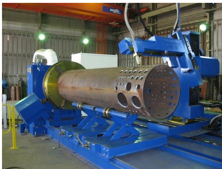
Figura 3 - Máquina Dedicada CNC para corte de tubos por Laser [14]
