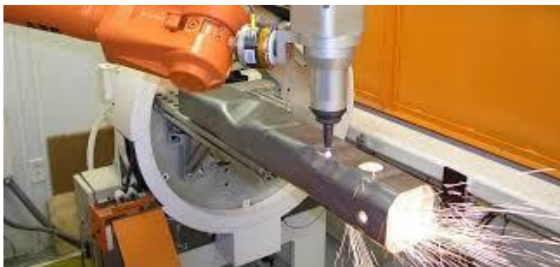
Figura 4 - Corte de tubo por robô industrial e Laser [15]
